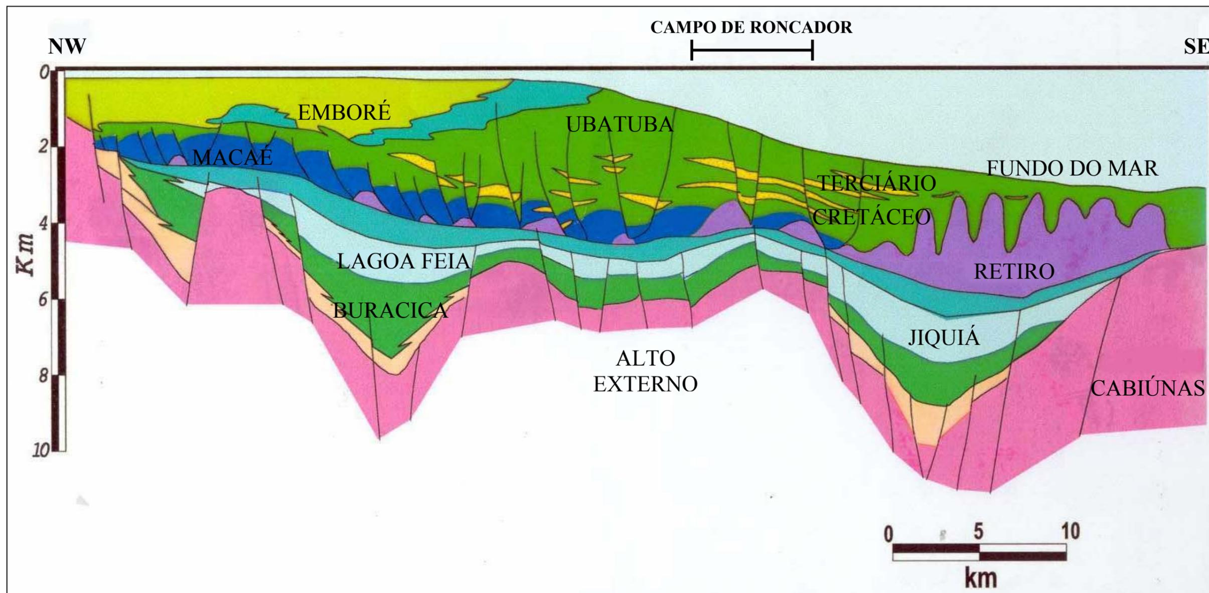
Figura 5.1.5.1-6. Seção Geológica Esquemática representativa do Campo de Roncador (PETROBRAS)
