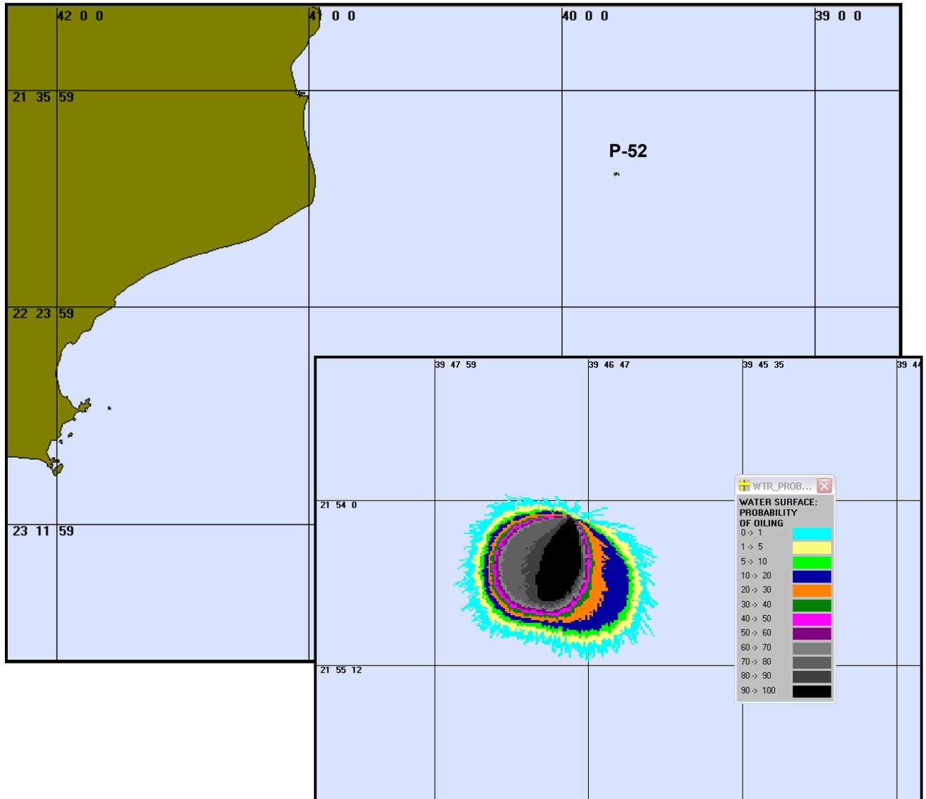
Figura 4 – Cenário P52 INV 8 20PPM. Contorno de probabilidades para um acidente ocorrendo na plataforma P-52 durante os meses de inverno (Maio a Agosto) com derrame de 8m<sup>3</sup> após 1 hora atingindo 20ppm.
