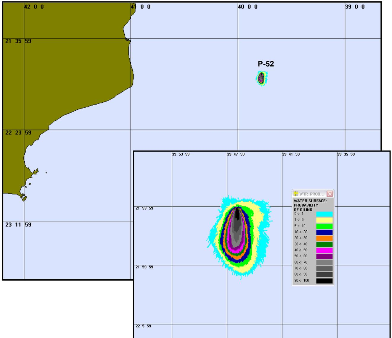
Figura 5 – Cenário P52 VER 200 6HORAS. Contorno de probabilidades para um acidente ocorrendo na plataforma P-52 durante os meses de verão (Janeiro a Março) com derrame de 200m<sup>3</sup> após 6 horas.
