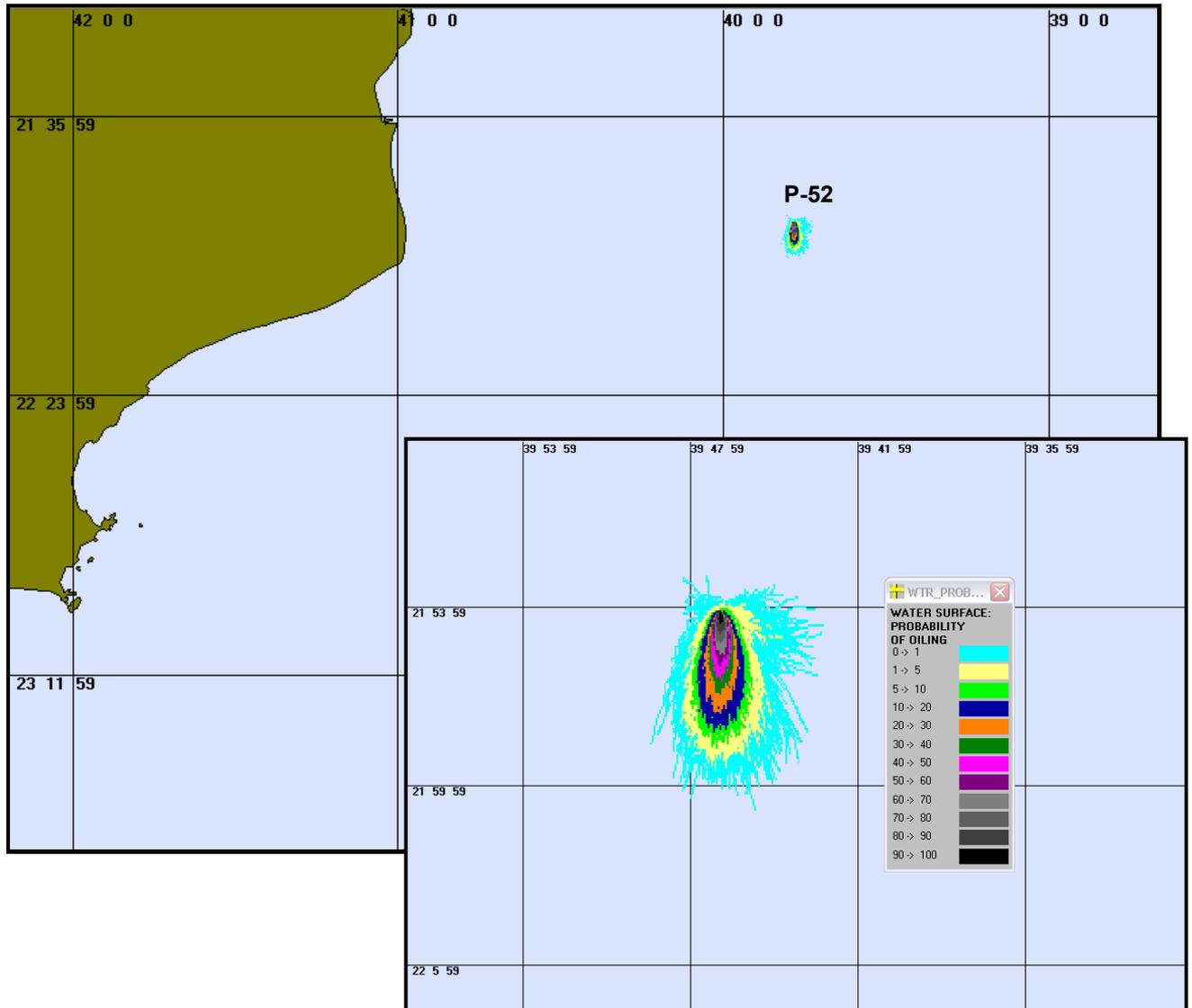
Figura 9 – Cenário P52 VER PIORCASO 6HORAS. Contorno de probabilidades para um acidente ocorrendo na plataforma P-52 durante os meses de verão (Janeiro a Fevereiro) com derrame de 90.000m<sup>3</sup> após 6 horas.
