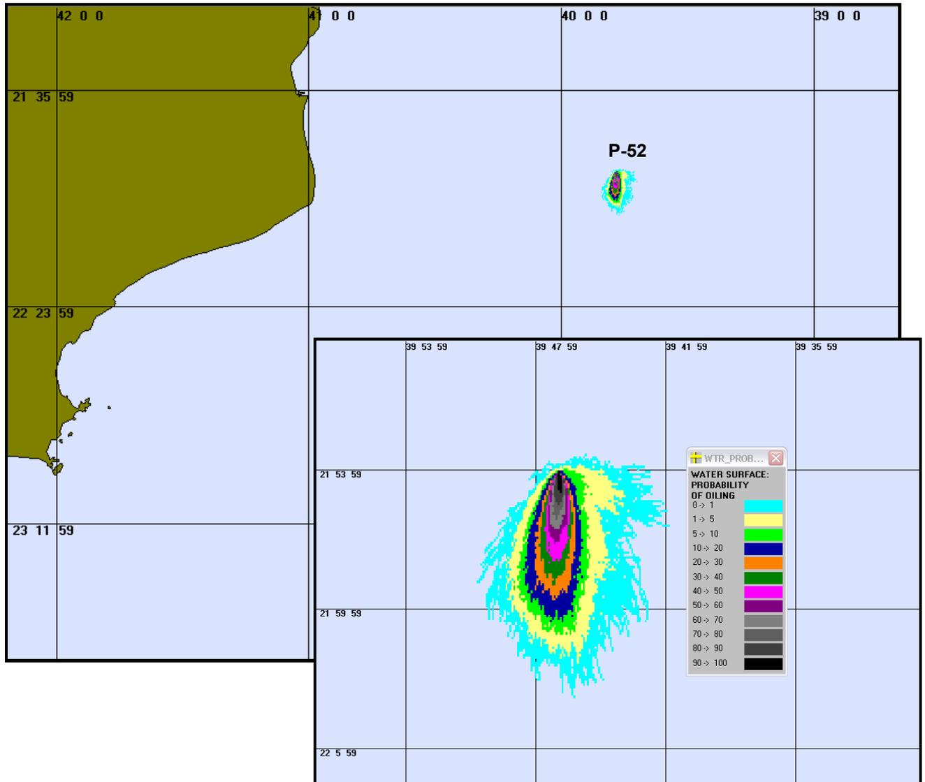
Figura 11 – Cenário P52 VER PIORCASO 9HORAS. Contorno de probabilidades para um acidente ocorrendo na plataforma P-52 durante os meses de verão (Janeiro a Fevereiro) com derrame de 90.000m<sup>3</sup> após 9 horas.
