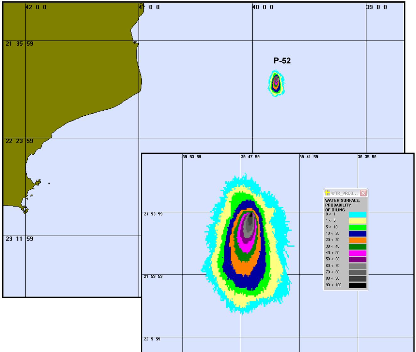
Figura 8 – Cenário P52\_INV\_200\_9HORAS. Contorno de probabilidades para um acidente ocorrendo na plataforma P-52 durante os meses de inverno (Maio a Agosto) com derrame de 200m<sup>3</sup> após 9 horas.
