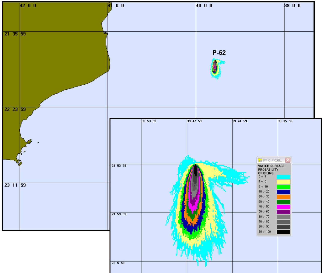
Figura 13 – Cenário P52 VER PIORCASO 12HORAS. Contorno de probabilidades para um acidente ocorrendo na plataforma P-52 durante os meses de verão (Janeiro a Fevereiro) com derrame de 90.000m<sup>3</sup> após 12 horas.
