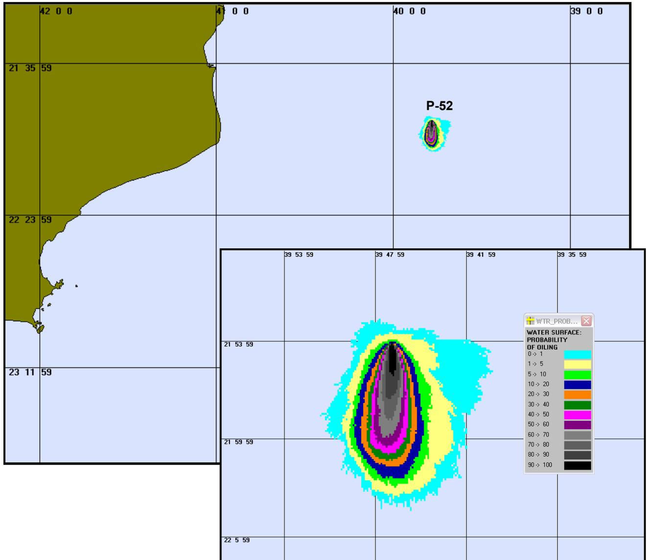
Figura 7 – Cenário P52 VER 200 9HORAS. Contorno de probabilidades para um acidente ocorrendo na plataforma P-52 durante os meses de verão (Janeiro a Fevereiro) com derrame de 200m<sup>3</sup> após 9 horas.
