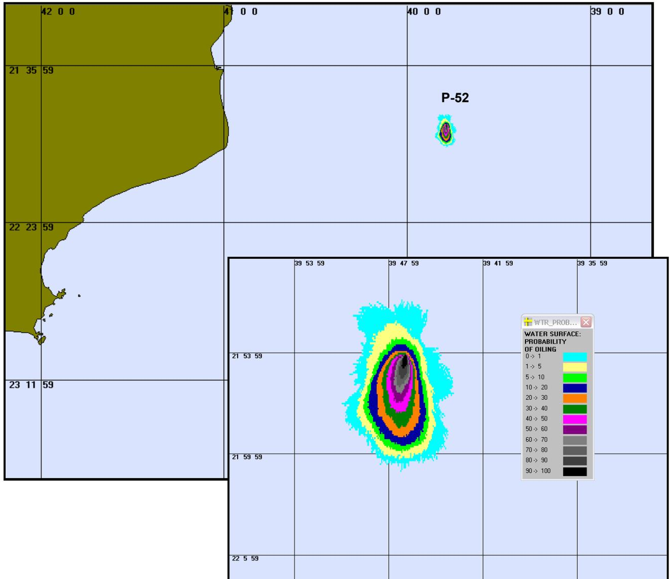
Figura 6 – Cenário P52 INV 200 6HORAS. Contorno de probabilidades para um acidente ocorrendo na plataforma P-52 durante os meses de inverno (Maio a Agosto) com derrame de 200m<sup>3</sup> após 6 horas.
