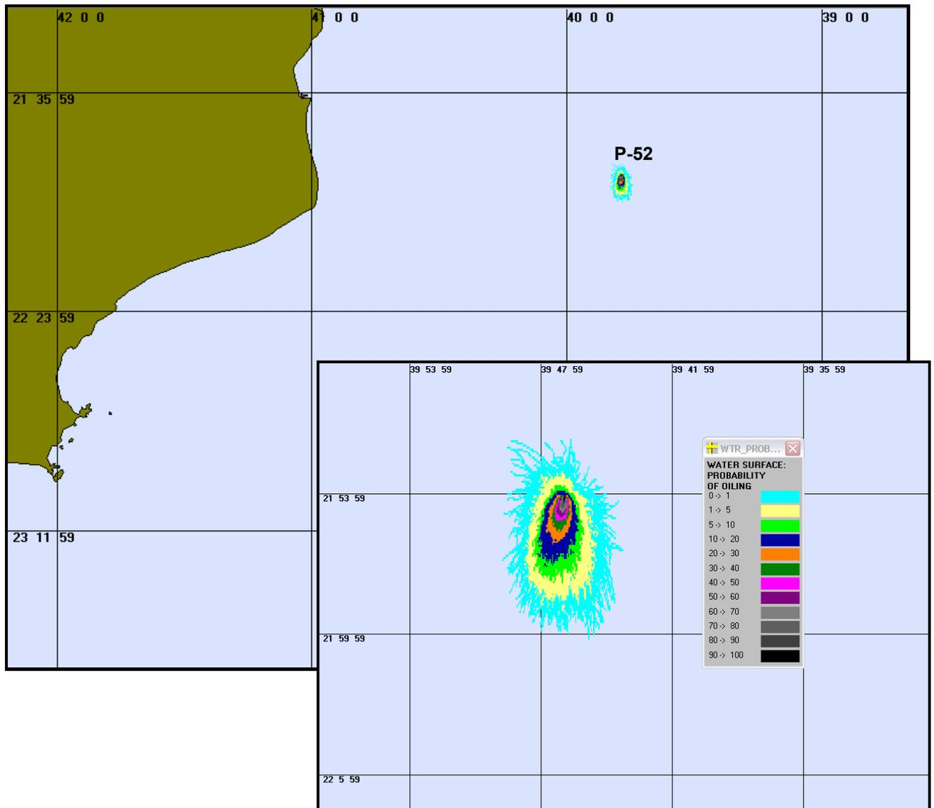
Figura 10 – Cenário P52 INV PIORCASO 6HORAS. Contorno de probabilidades para um acidente ocorrendo na plataforma P-52 durante os meses de inverno (Maio a Agosto) com derrame de 90.000m<sup>3</sup> após 6 horas.
