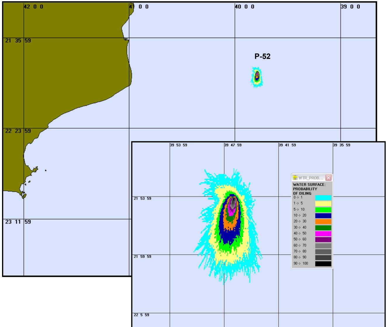
Figura 12 – Cenário P52 INV PIORCASO 9HORAS. Contorno de probabilidades para um acidente ocorrendo na plataforma P-52 durante os meses de inverno (Maio a Agosto) com derrame de 90.000m<sup>3</sup> após 9 horas.
