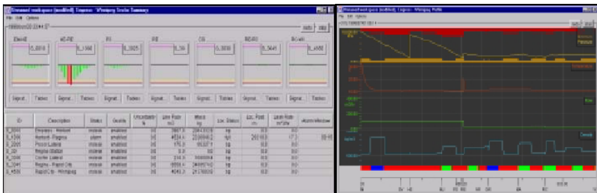
Figura 2.4-29 Telas ilustrativas do software LeakWarn, informando as condições operacionais de um duto
