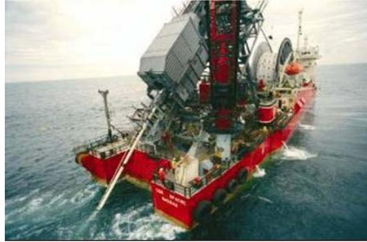
Figura 2.4-20 Tipo de embarcação a ser empregada nas atividades de instalação dos dutos
