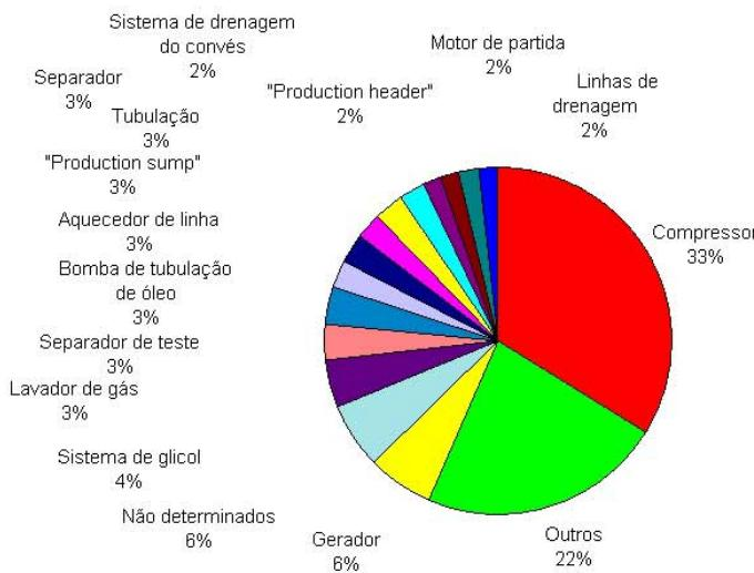
**Figura 8.1.2-5. Equipamentos envolvidos em incêndios / explosões**
