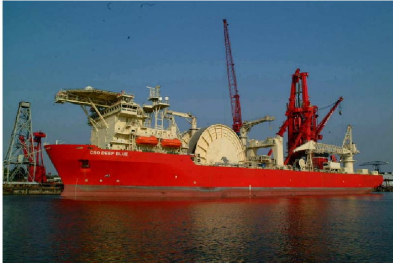
Figura 2.4-38. Embarcação de lançamento do oleoduto
