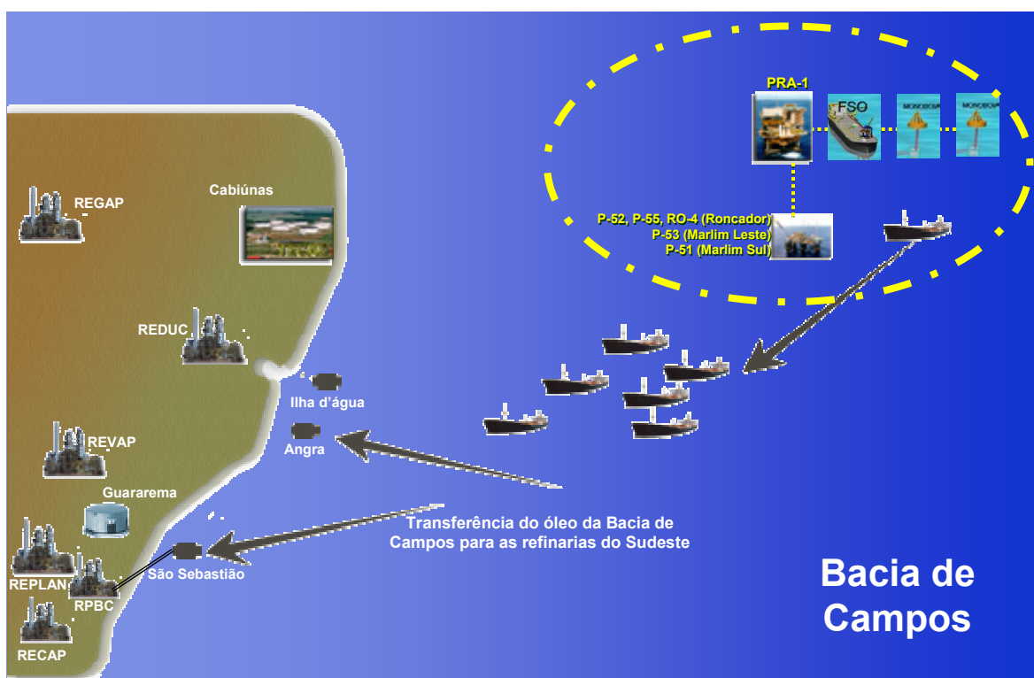
Figura II.8-1 - Desenho esquemático do Sistema de Rebombeio Autônomo e Escoamento dos Campos de Marlim Leste, Marlim Sul e Roncador. Fonte: Petrobras.
