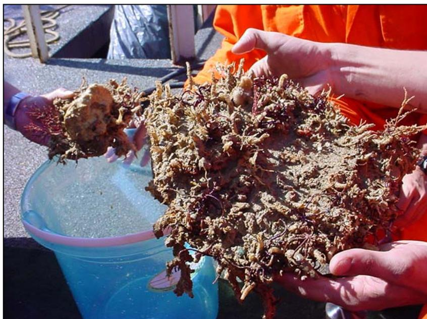
**Figura II.5.1.3-20** - Sedimento carbonático coletado com o Box Corer, durante a campanha de agosto de 2002. Fonte: PETROBRAS/HABTEC (2002a).
