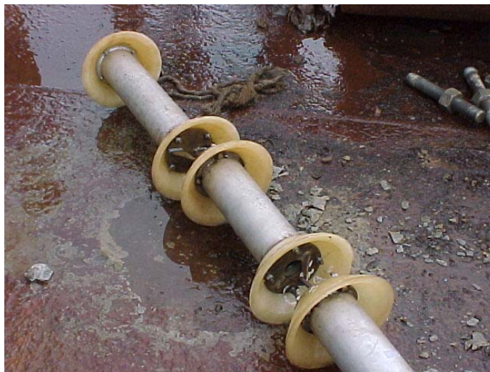
Figura II.2.4-23 - Exemplo de pig utilizado em operações de limpeza.
