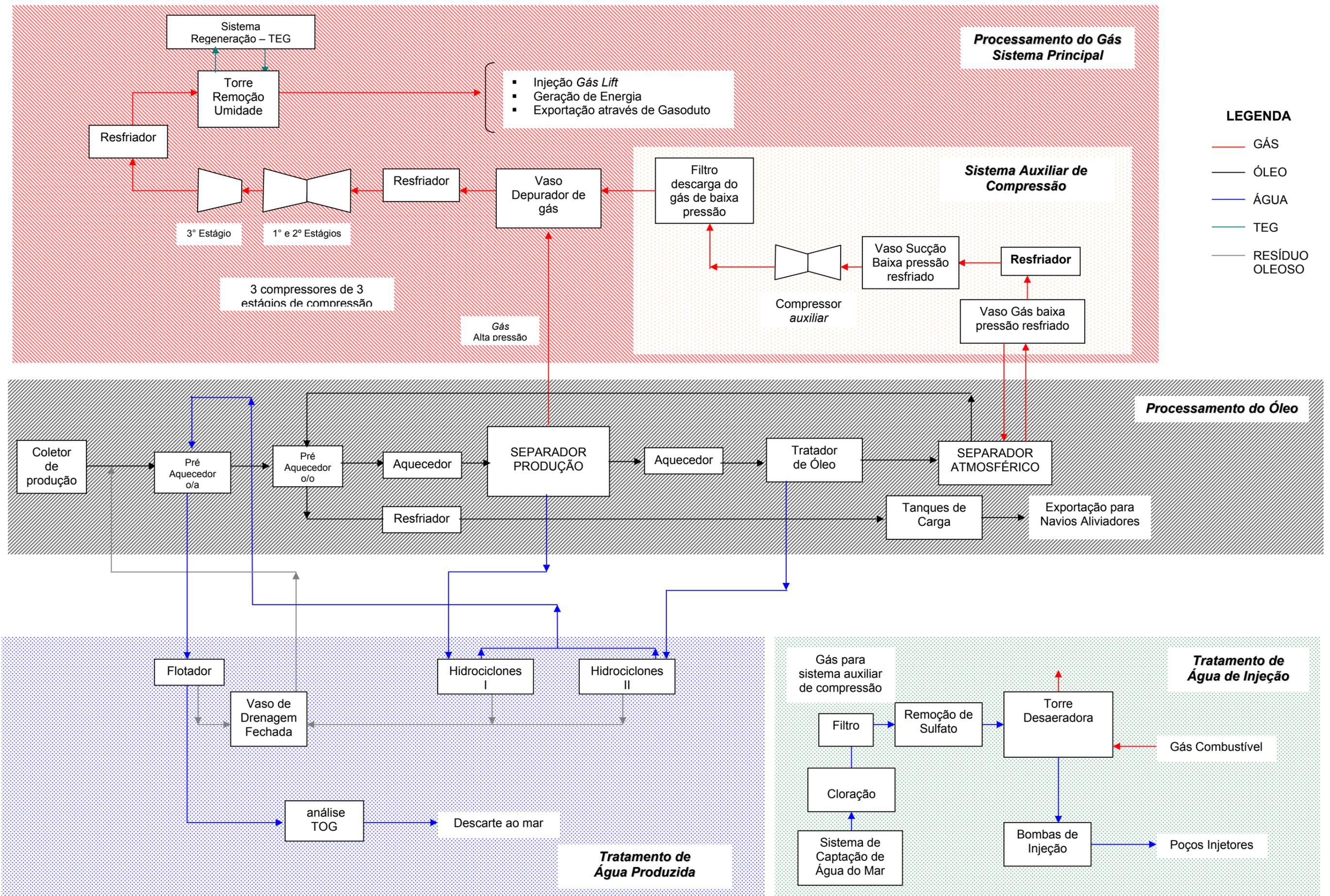
Figura 2.4-2. Fluxograma Simplificado de Processo FPSO P-54
