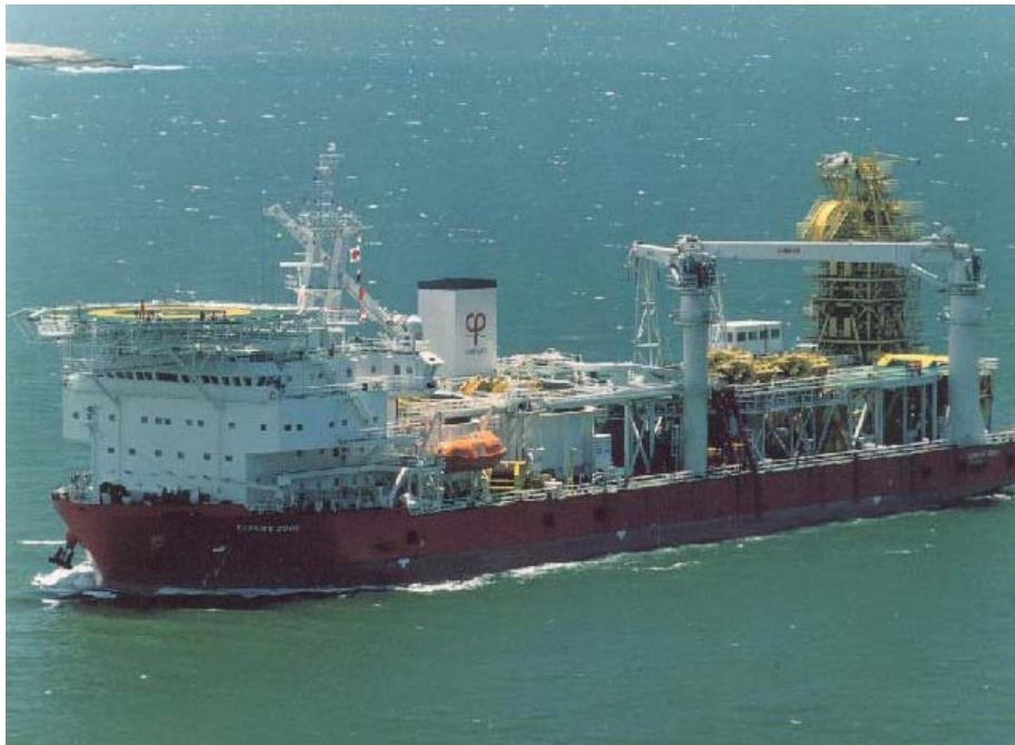
Figura 2.4-28. Embarcação de lançamento de linhas flexíveis Sunrise 2000 .
