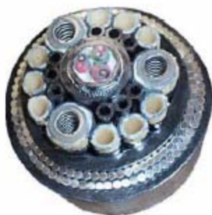
Figura 2.4-15. Foto representativa de um umbilical flexível. Fonte: Petrobras
