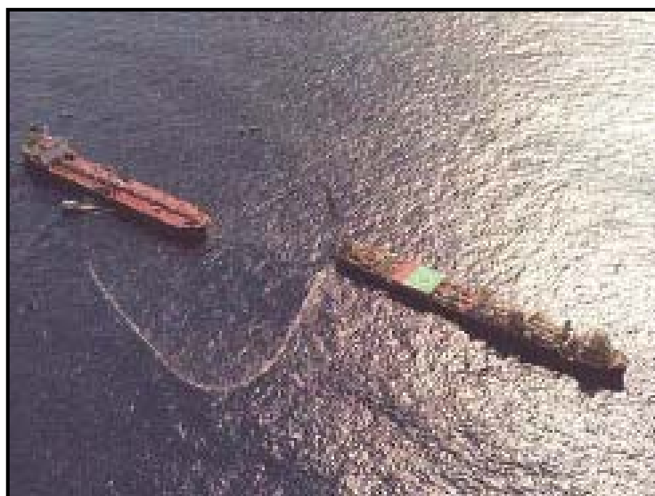
Figura II.8.1.1-18: Exemplo de operação de transferência de óleo in tandem .
