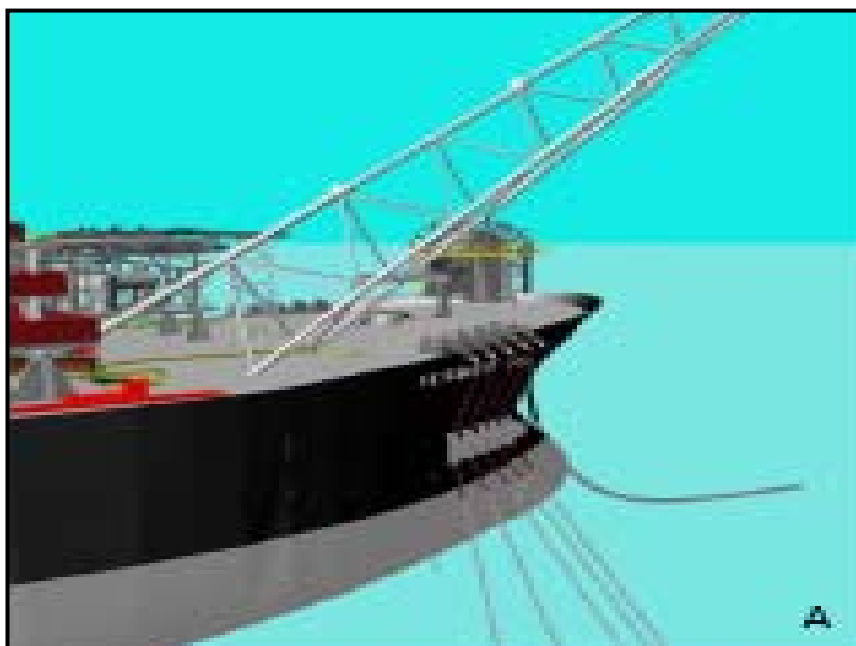
Figura II.8.1.1-19: Ilustração do sistema de mangotes de offloading instalado na proa do FPSO.
