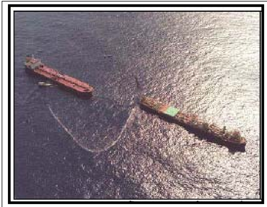
Figura II.2.4-16 - Exemplo de operação de transferência de óleo in tandem .
