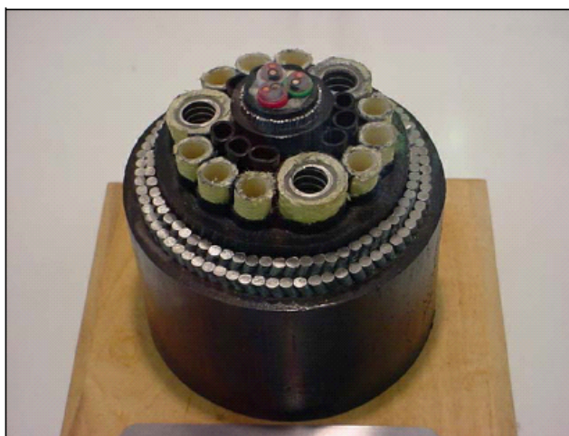
Figura II.2.4-11 - Vista da seção transversal de um Umbilical Eletro-Hidráulico. Fonte: PETROBRAS.
