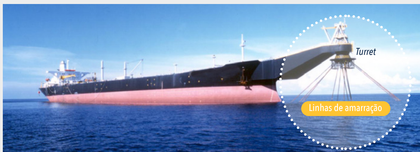
Figura 3 - Exemplo de sistema de ancoragem do tipo turret
