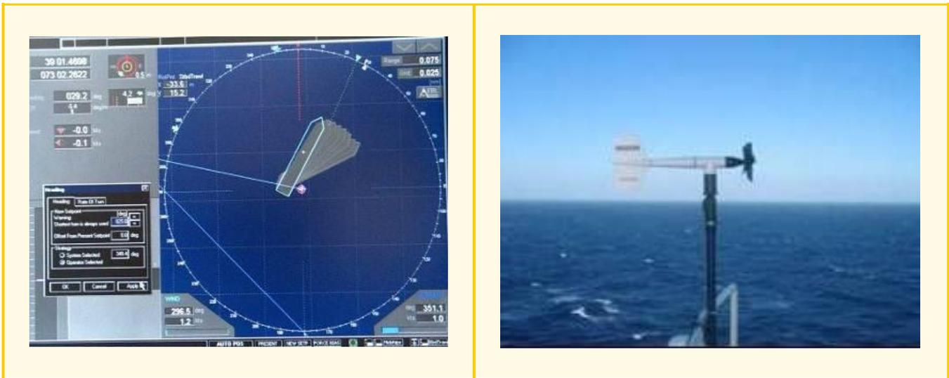
Figura 6 - Exemplos de equipamentos para monitoramento de variáveis de suporte à operação e controle, como posicionamento e direção do vento.
