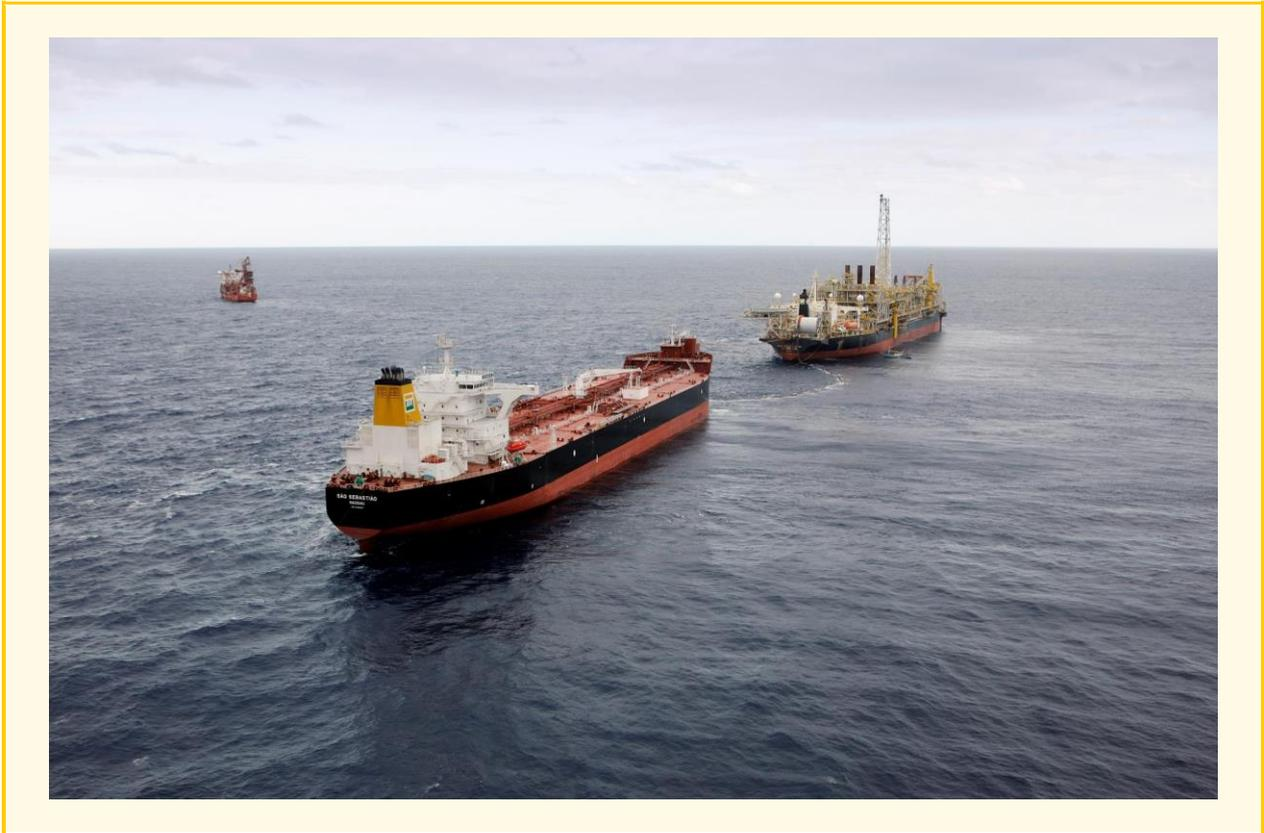
*Figura 3 - Exemplo de operação de transferência de óleo (offloading). Fonte: André Motta de Souza / Banco de Imagens Petrobras*
