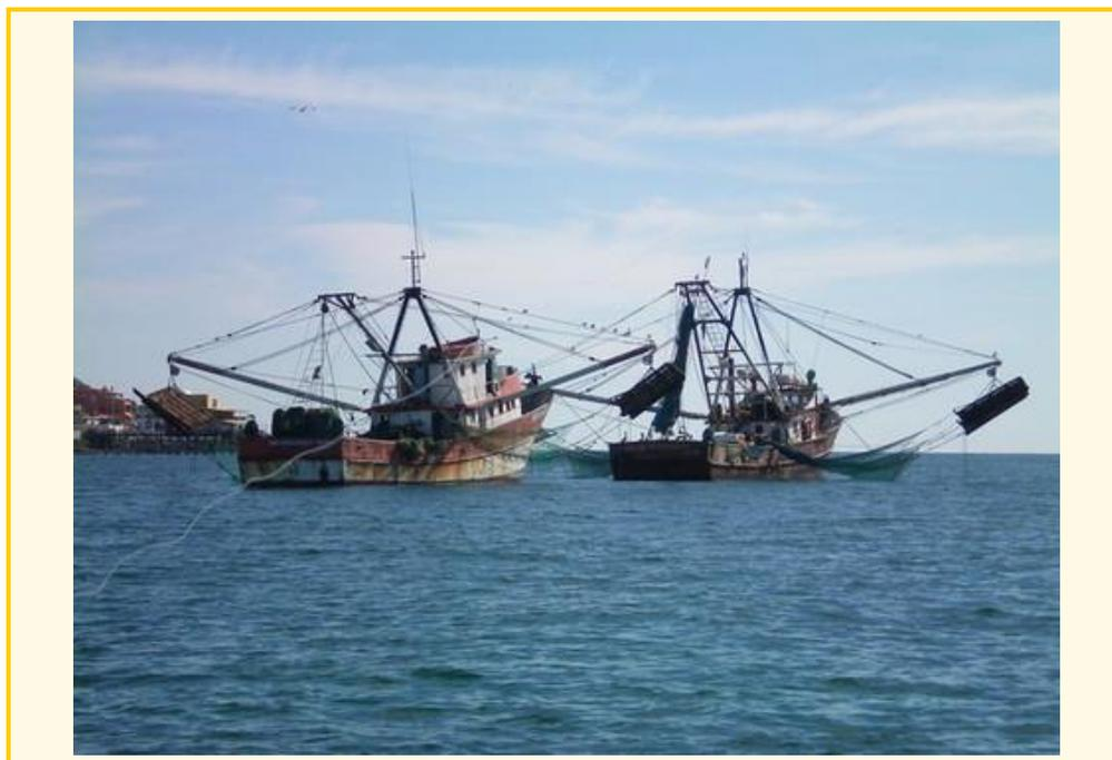
Figura 25 - Embarcações da frota permissionada para a captura de arrasto duplo, utilizado para a pesca do camarão-rosa.
