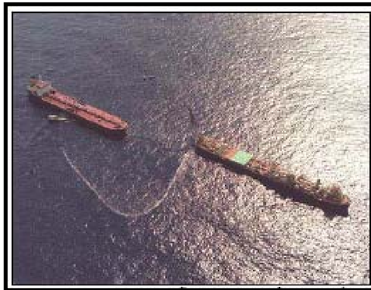
Figura II.2-32: Exemplo de operação de transferência de óleo in tandem .
