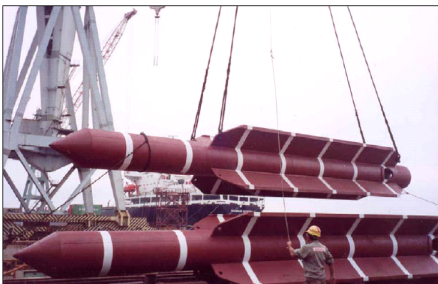
Figura II.2-38: Estaca do tipo torpedo a ser utilizada na ancoragem do FPSO CIDADE DO RIO DE JANEIRO
