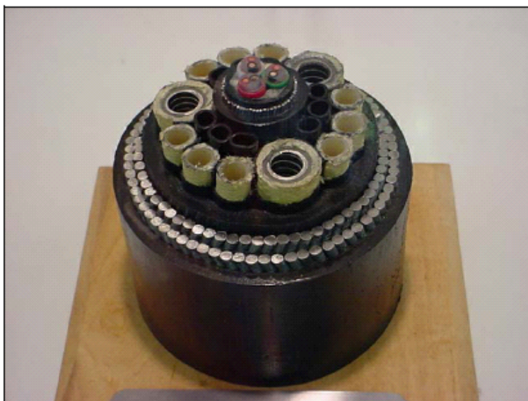
Figura II.2-19: Vista da seção transversal de um Umbilical Eletro-Hidráulico. Fonte: Petrobras.
