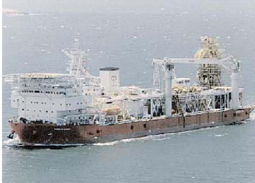
**Figura II.2.4-47** - Foto do tipo de embarcação que pode ser utilizada na instalação das linhas de fluxo de processo no Campo de Marlim Leste.
