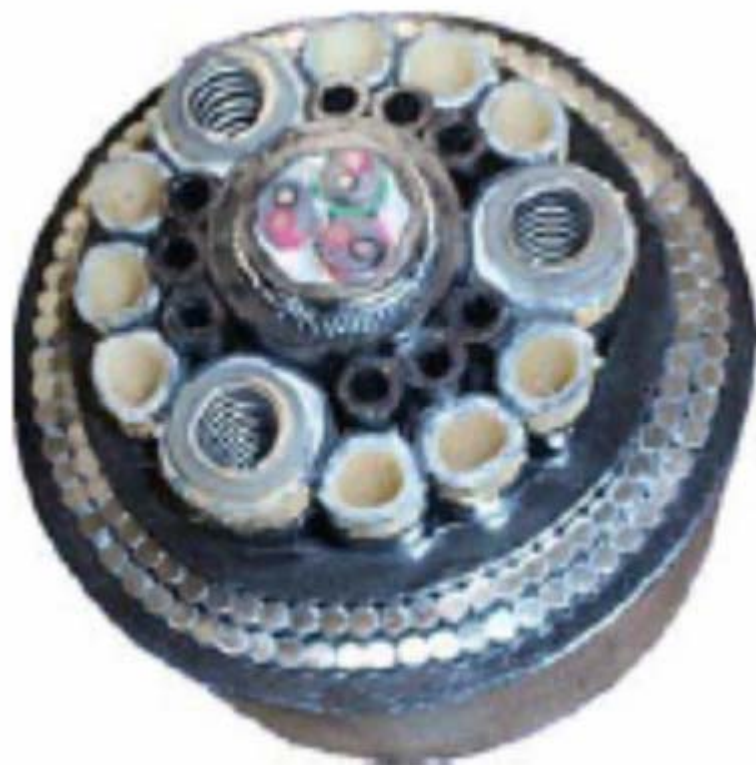
Figura II.2.4-28 - Foto representativa de um umbilical flexível. Fonte: PETROBRAS
