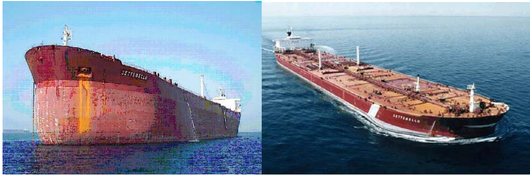
Figura II.2.4-9 - Fotos do navio Settebello, cujo casco será convertido para o FPU P-53
