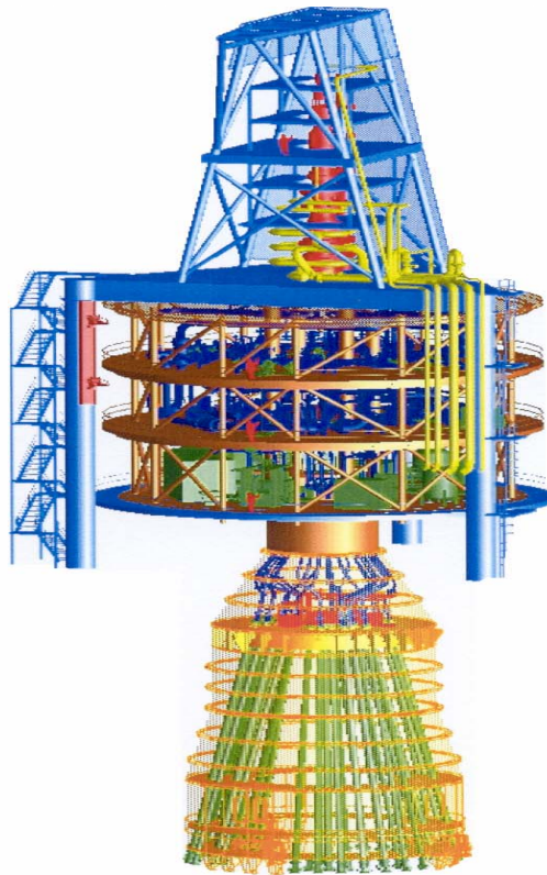
Figura II.2.4-13 - Estrutura do turret.
