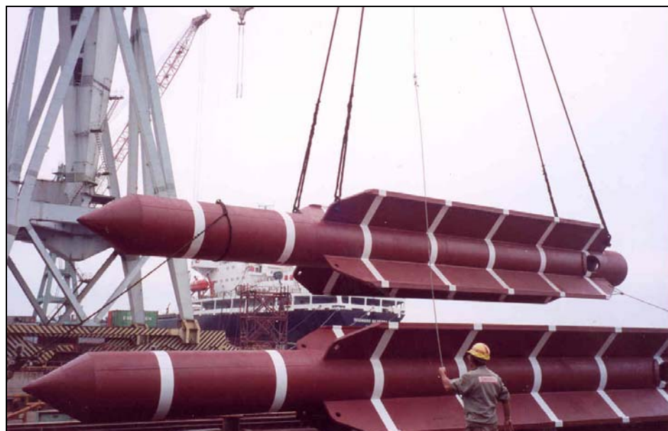
Figura II.2.4-5 - Estaca do tipo torpedo a ser utilizada na ancoragem do FPU P-53
