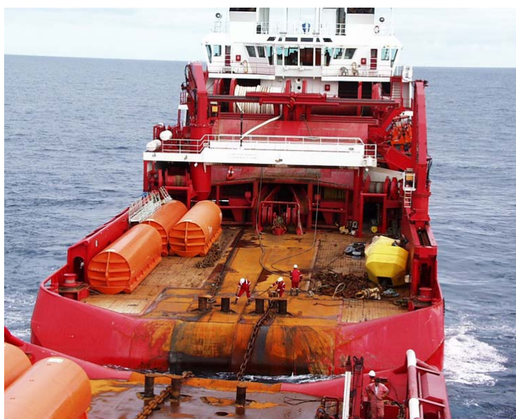
Figura II.2.4-7 - Foto de uma embarcação de suporte tipo AHV típica.
