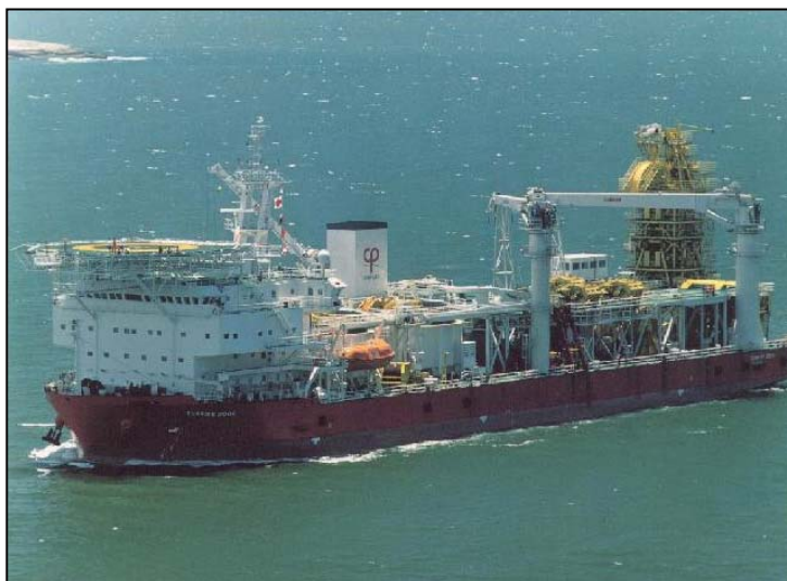
Figura 2.4-30: Embarcação Sunrise 2000 que irá realizar os lançamento das linhas de produção.
