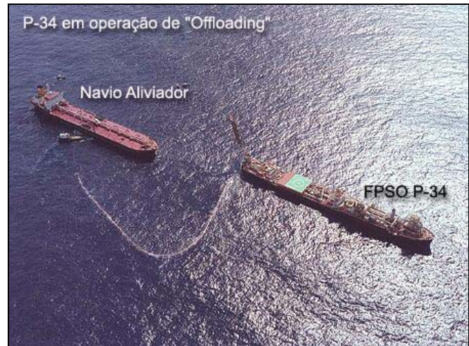
Figura 2.4-7: Barco de apoio levando o mangote de transferência para o navio aliviador.
