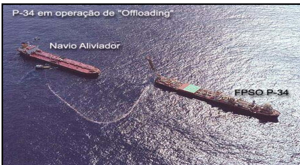
Figura 2.1.4-2: Barco de apoio instalando o mangote de transferência no navio aliviador.
