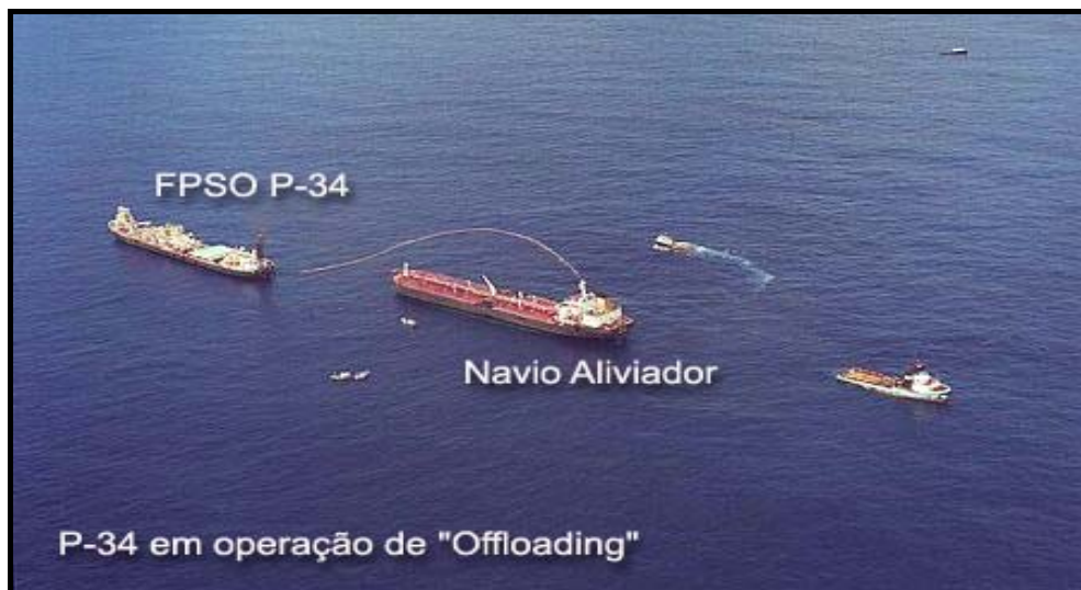
Figura 2.1.4-3: Operação de offloading acompanhada por barcos de apoio.
