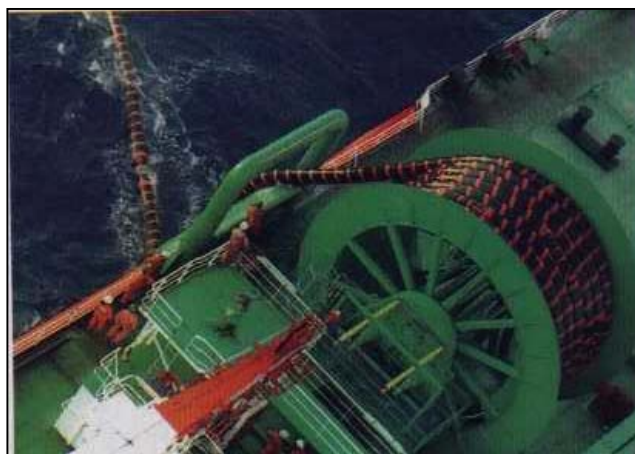
Figuras 4.1.2-3 e 4.1.2-4 : Mangote para transferência de óleo e carretel para enrolamento do mesmo.
