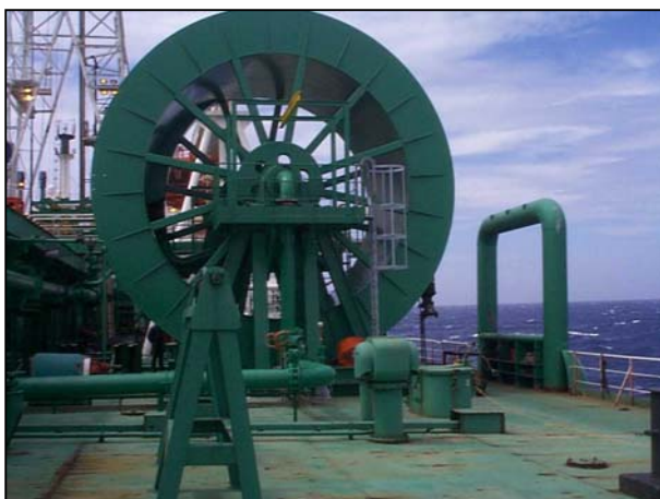
Figuras 4.1.2-3 e 4.1.2-4 : Mangote para transferência de óleo e carretel para enrolamento do mesmo.
