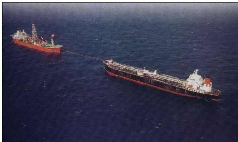
Figura 4.1.2-2: Vista área de uma operação de offloading do FPSO Seillean.
