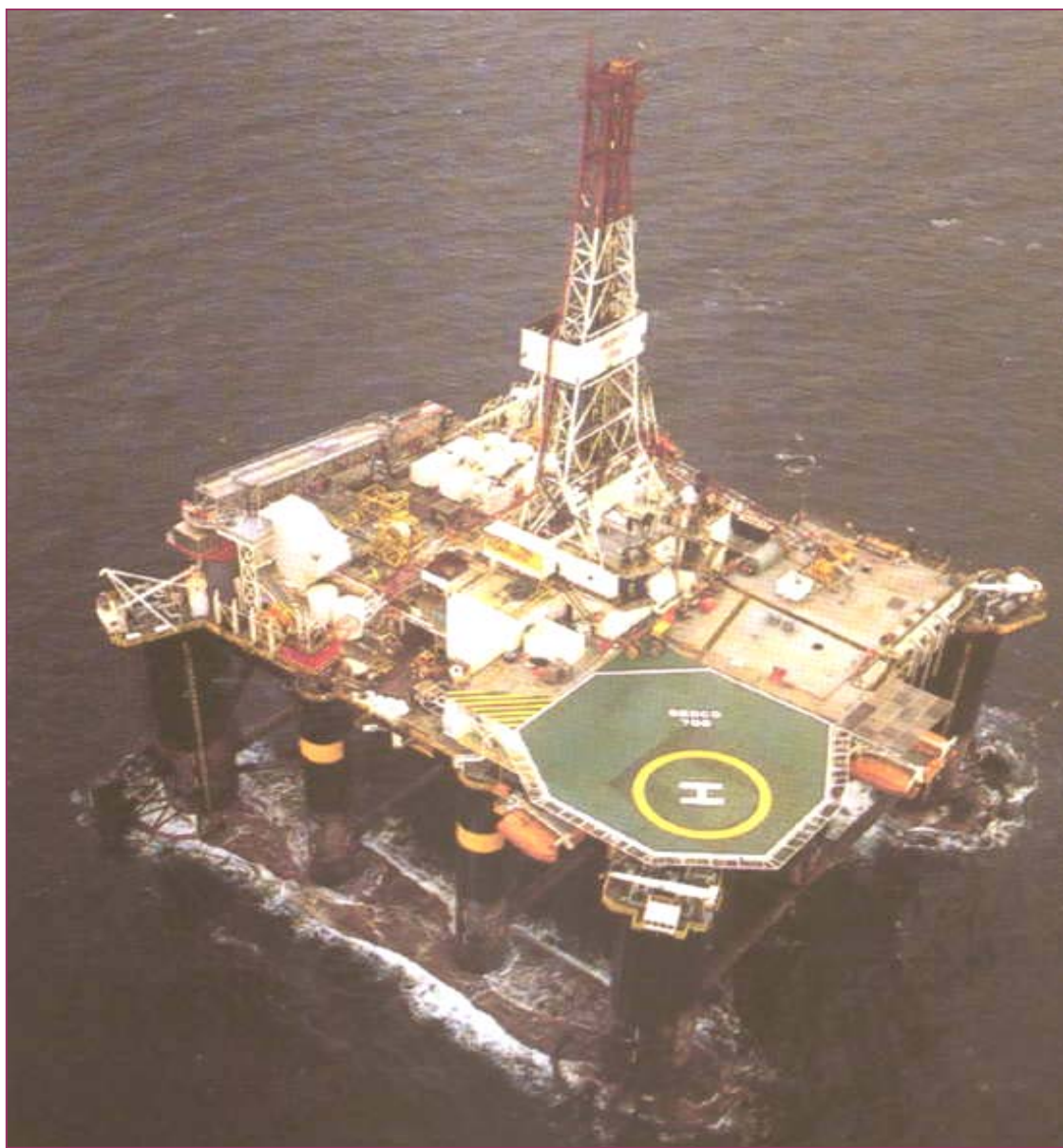
Figura 3: Transocean SEDCO-706 – Unidade de Perfuração Móvel Semi-Submersível
