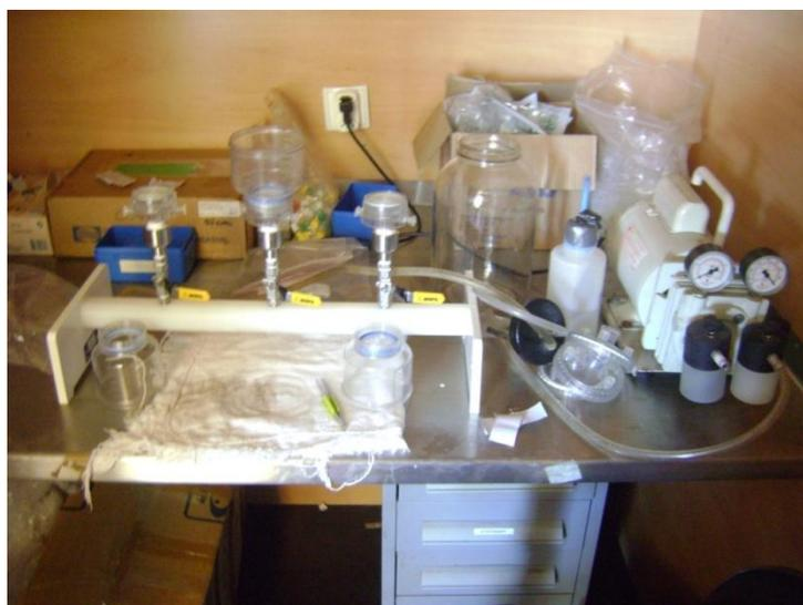
**Figura 12.** Kits de filtração e bomba de vácuo no laboratório seco.
