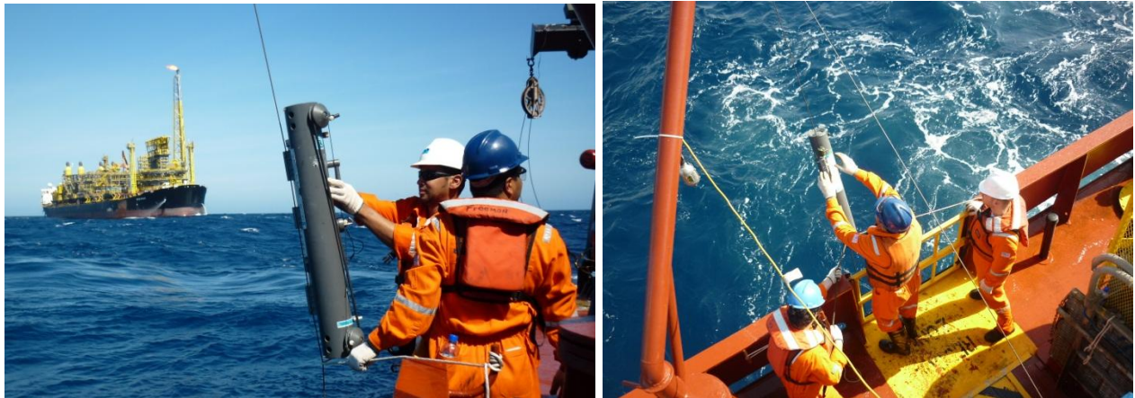
Figura 4.4.2-1: Operação com as garrafas Go-Flo.
