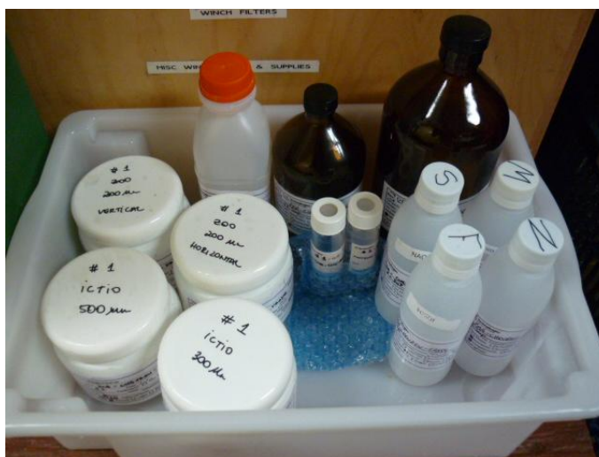
Figura 4.4.2-2: Kit utilizado para o acondicionamento das amostras de água.
