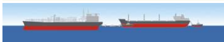
Transferência do óleo para o navio aliviador. Embarcação de apoio auxilia para manter a posição do navio aliviador.
