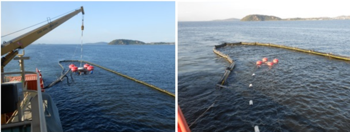
FIGURA 12 - Exercício com lançamento de barreiras e skimmer, realizado no dia 9 de setembro de 2013 pela embarcação Campos Contender.
