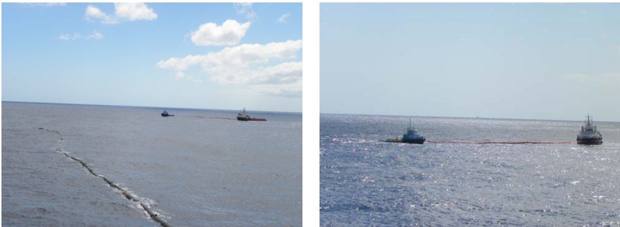
FIGURA 15 - Treinamento de lançamento de barreira, realizado no dia 29 de agosto pela embarcação TS Fissurado
