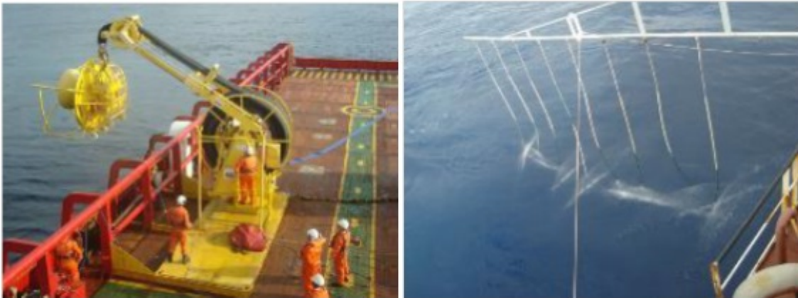
FIGURA 2 - Lançamento de Skimmer e aplicação de dispersante, 31 de setembro de 2013 pela embarcação MV Magé.
