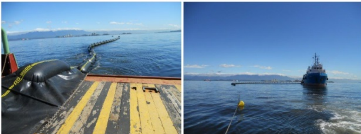
FIGURA 8 - Exercício: Lançamento de Barreira e exercício de formação em “U” e “J”, realizado no dia 28 de novembro de 2013 pela embarcação MV Macaé.
