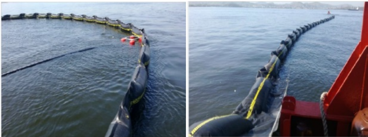
FIGURA 10 - Lançamento barreiras e Operação do Skimmer, realizado no dia 19 de setembro de 2013 pela embarcação Maricá.
