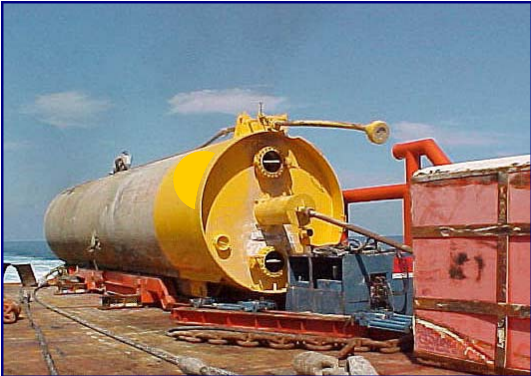
FIGURA II.2.4.2.L-5: VISÃO GERAL DE UMA ÂNCORA DE SUÇÃO. FONTE: www.delmarus.com
