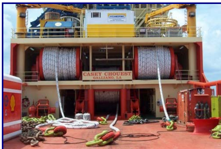
FIGURA II.2.4.2.L-7: CONVÉS DE OPERAÇÃO DE UM AHTS, COM TRECHOS DE CORRENTE E DE LINHAS DE POLIÉSTER. FONTE: www.delmarus.com
