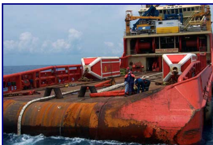
FIGURA II.2.4.2.L-8: OPERAÇÃO DE LANÇAMENTO DE TRECHO DE LINHA DE POLIÉSTER. FONTE: www.delmarus.com
