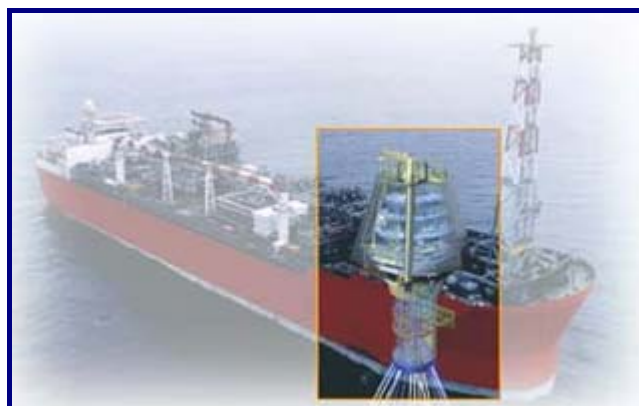
FIGURA II.2.4.2.L-2: LOCALIZAÇÃO DO TURRET INTERNA NA EMBARCAÇÃO E ESQUEMA DE SAÍDA DE LINHAS DE ANCORAGEM. FONTE: www.singlebuoy.com/html/productservices/IntTurret.htm
