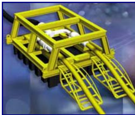
FIGURA II.2.4.2.B-1: ESTRUTURA DE APOIO DO TIPO SLED
