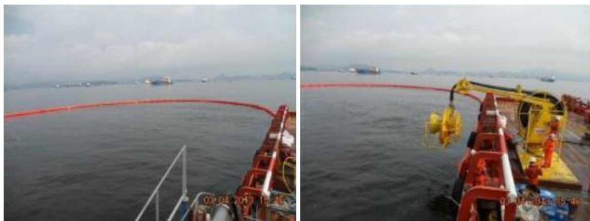
Figura 2 – Formação de Barreira em “U” e Barreira em “J” com lançamento de Skimmer, realizado no dia 03 de março de 2013 pela embarcação MV Magé.
