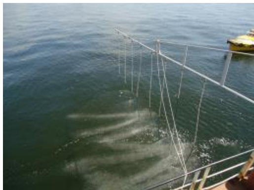
Sistema de aplicação de dispersantes
