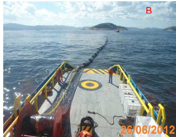
**FIGURA 5 - Preparo da barreira de contenção (enchimento dos gomos) no convés (FIGURA 6A) para seu respectivo lançamento a partir da embarcação TS Fissurado (FIGURA 6B) durante o exercício simulado realizado em 26 de junho de 2012**
