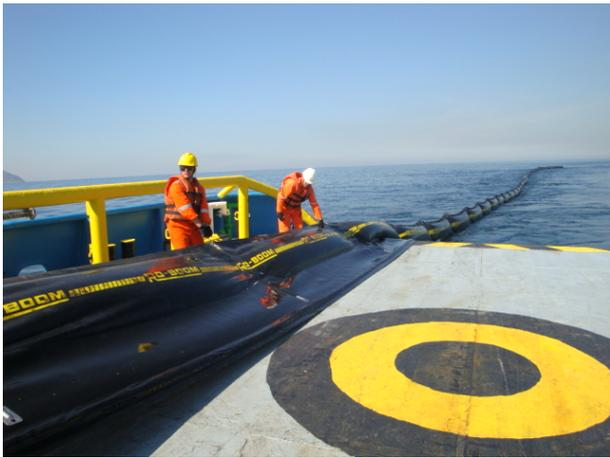
**FIGURA 1 - Preparo da barreira de contenção no convés para seu lançamento a partir da embarcação TS Fissurado durante o exercício simulado realizado em 30 de maio de 2012.**
