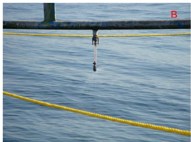
**FIGURAS 3 e 4 - Simulação do uso de dispersantes químicos durante o exercício simulado realizado em 30 de maio de 2012, na embarcação TS Fissurado. Destaque para o braço do sistema de aspersão montado na embarcação TS Fissurado com uso de água do mar para simular a dispersão química (A) e detalhe do bico aspersor usado (B)**
