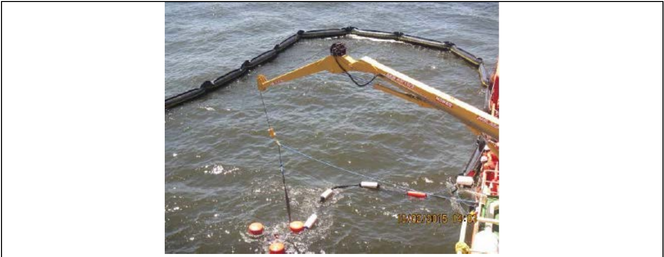
FIGURA 11 – Operação do recolhedor de óleo durante o treinamento realizado no dia 13/02/15, com a embarcação Reedbuck na Baía de Guanabara.
