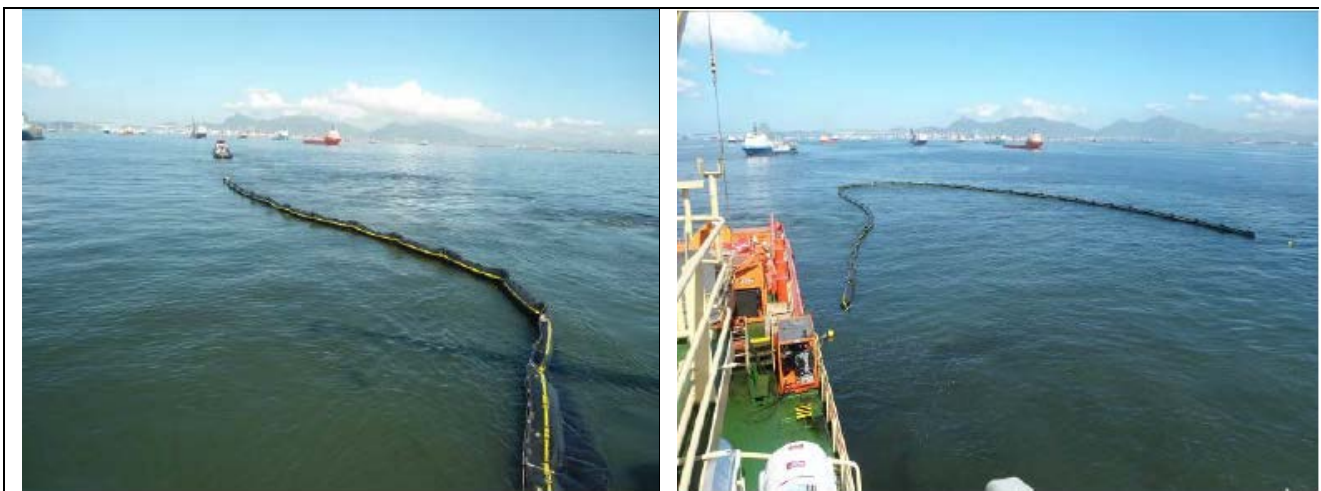
FIGURA 7 – Lançamento de Barreiras e Formação de Cercos de Contenção e Recolhimento realizados no treinamento do dia 21/05/15, com a embarcação Campos Contender na Baía de Guanabara.
