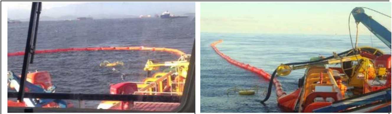
FIGURA 3 – Operação do Recolhedor de Óleo realizada nos treinamentos dos dias 22/02/15 e 26/05/15, com embarcação MV Magé , na Baía de Guanabara e no Campo de Frade, respectivamente.
