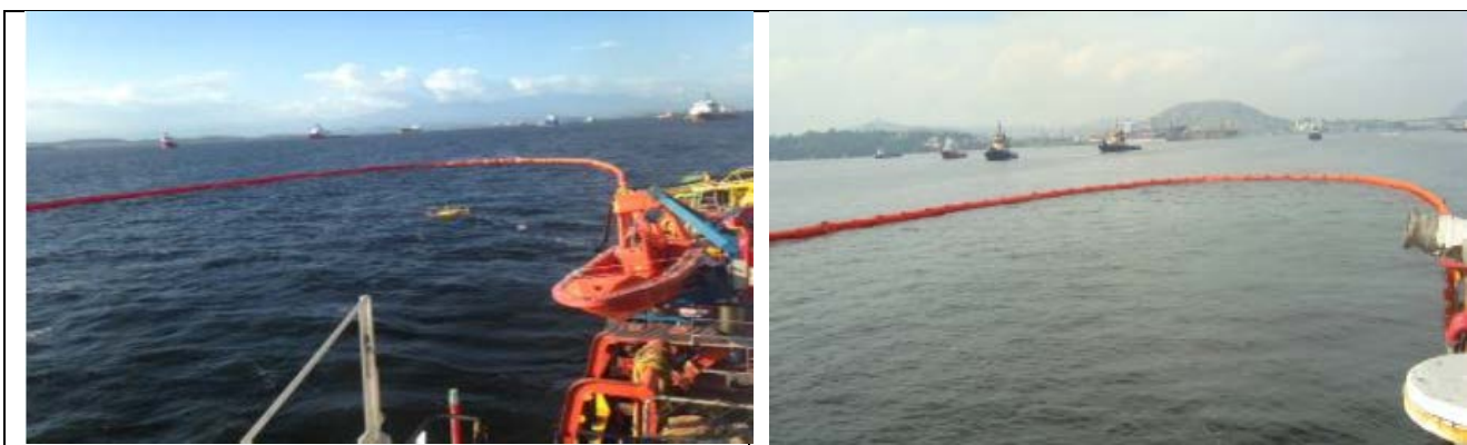
FIGURA 2 – Formação de Cercos de Contenção e Recolhimento realizados nos treinamentos dos dias 22/02/15 e 20/03/15, com a embarcação MV Magé na Baía de Guanabara.
