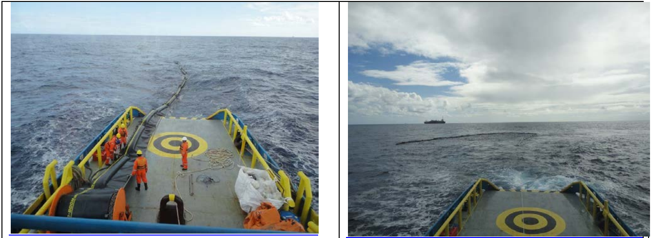
FIGURA 6 – Lançamentos de Barreira e Formação de Cercos de Contenção e Recolhimento realizados nos treinamentos dos dias 16/03/15, 05/04/15 e 15/05/15, com a embarcação TS Fissurado no Campo de Frade.
