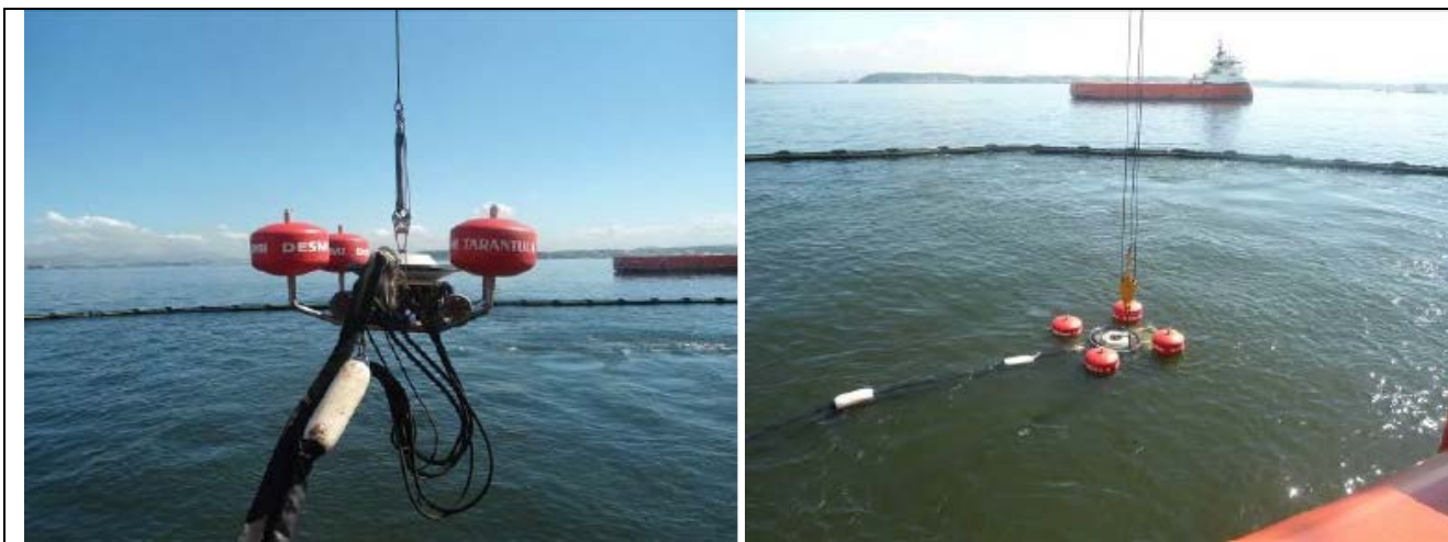
FIGURA 8 – Lançamento e Operação do Recolhedor de Óleo realizados no treinamento do dia 21/05/15, com embarcação Campos Contender na Baía de Guanabara.
