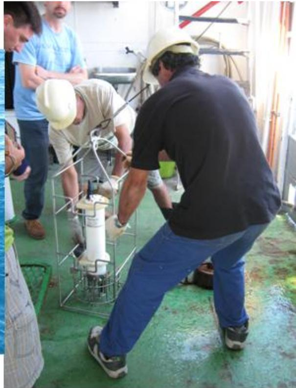
Figura 14. CTD (Conductivity-Teperature-Depth) após a coleta dos dados em uma estação oceanográfica.
