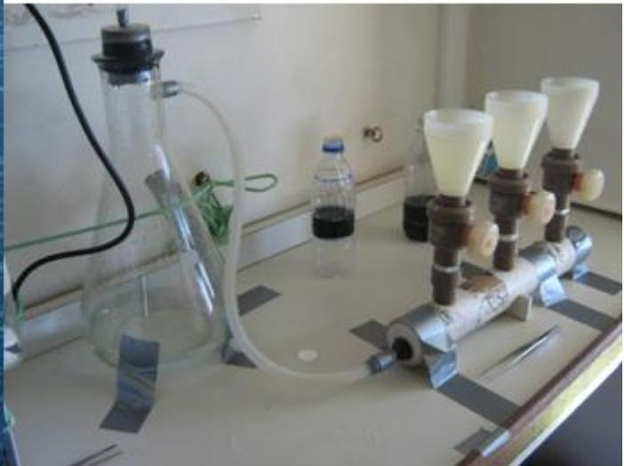
Figura 15. Água superficial sendo coletada na foto à esquerda e o equipamento utilizado para filtrar e armazenar a clorofila durante o embarque na foto à direita.
