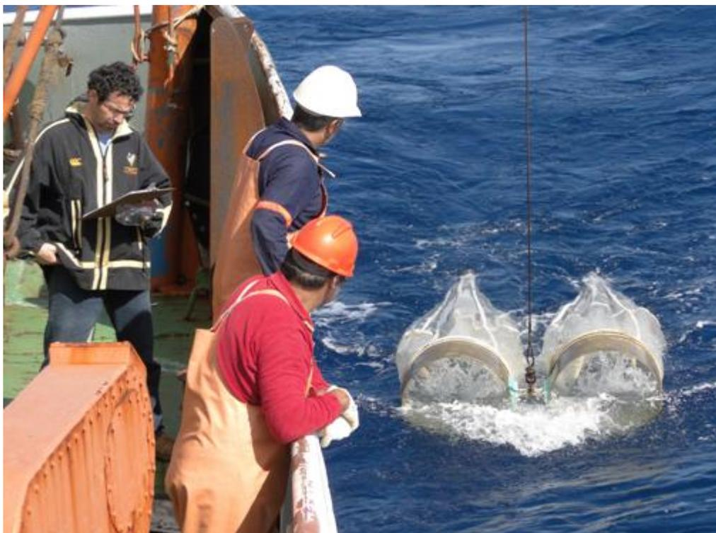
Figura 17. Coleta de zooplâncton utilizando a rede de bongo para posterior identificação e quantificação.
