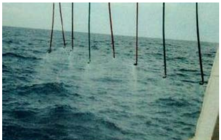
FIGURA 4 – Sistema de aplicação de dispersantes da embarcação MV Magé testado em 17 de setembro de 2014 e em 27 de outubro de 2014.
