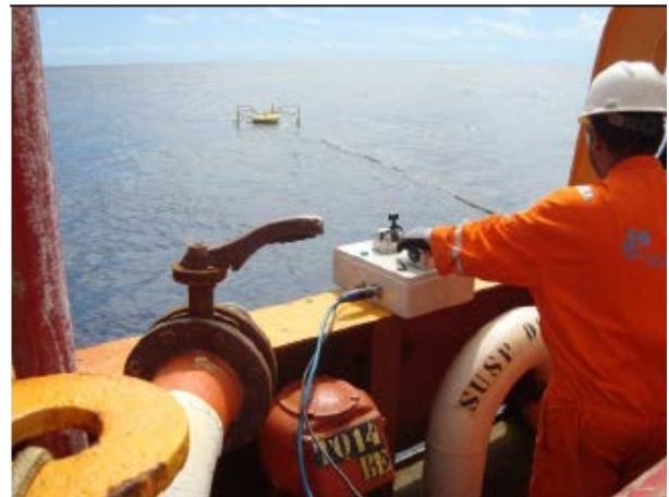
FIGURA 3 – Lançamento do recolhedor de óleo e operação de recolhimento durante exercício realizado em 23 de setembro de 2014 pela embarcação MV Magé.
