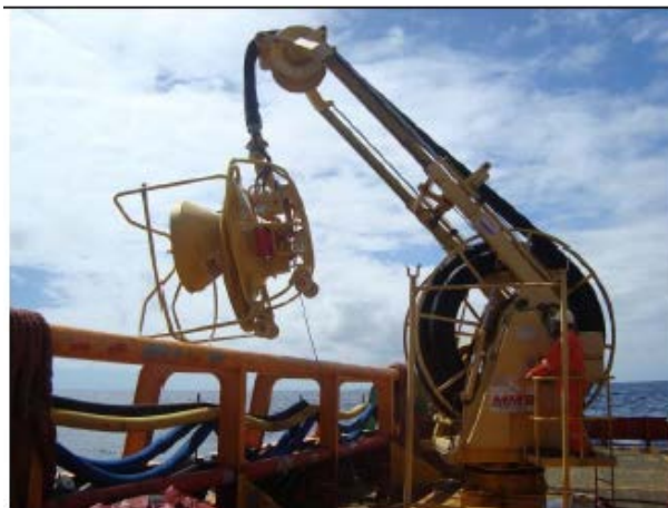
FIGURA 3 – Lançamento do recolhedor de óleo e operação de recolhimento durante exercício realizado em 23 de setembro de 2014 pela embarcação MV Magé.
