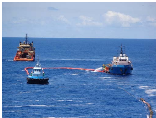
FIGURA 6 – Lançamento e Formação de barreira, realizada em 12 de novembro de 2014, com a embarcação TS Fissurado.
