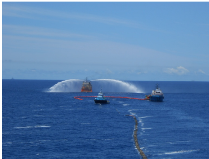
FIGURA 7 – Dispersão mecânica, realizada no dia 12 de novembro de 2014, pela embarcação Campos Contender.
