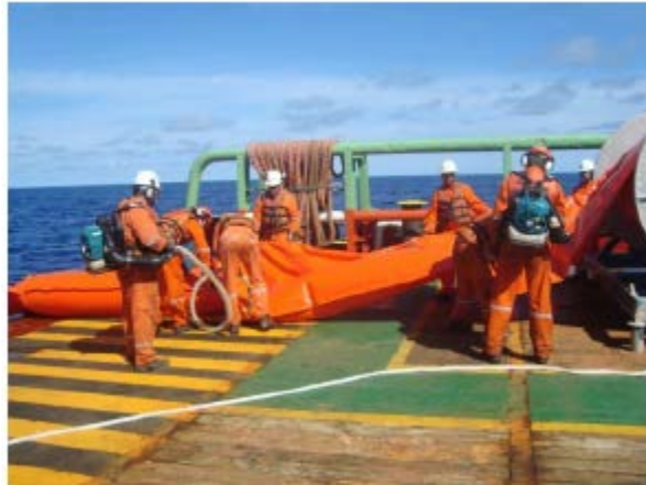
FIGURA 9 – Lançamento da barreira de contenção oceânica a partir da embarcação MV Magé durante o exercício simulado do dia 12/11/14.
