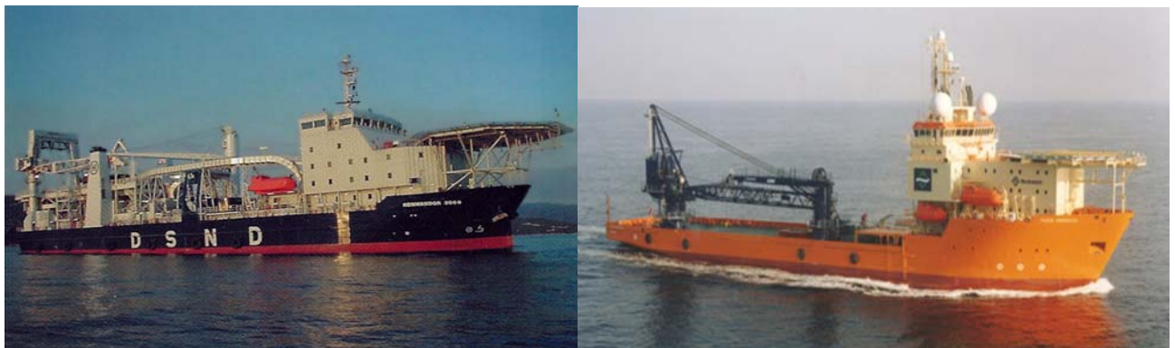
Figura 3.4.1-b. Fotos das embarcações DSND Kommandor 3000 e Torsa Perseus a serem utilizadas nos trabalhos de instalação das linhas de fluxo.
