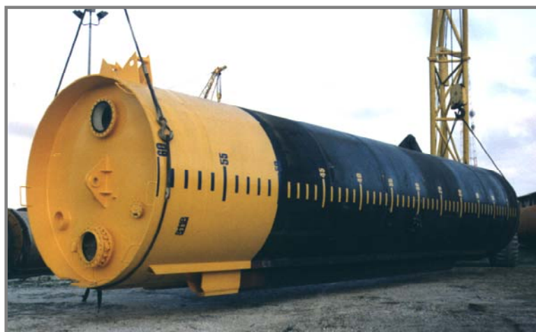
Figura 3.4.3-a. Âncora de sucção a ser utilizada na ancoragem do FPSO P-48
