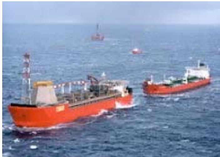
Figura 3.6.1-a. Exemplo de operação de transferência de óleo in tandem .
