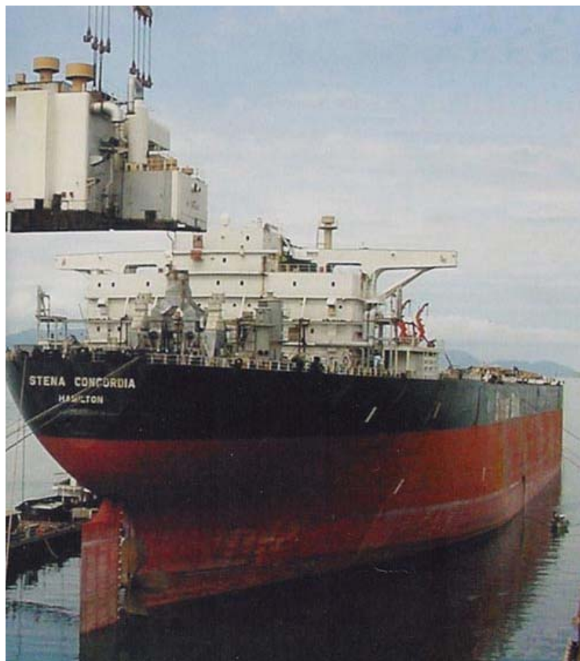
Figura 3.2-a. Foto do petroleiro Stena Concordia sendo convertido ao FPSO P-48. Fonte: Offshore Technology ( www.offshore-technology.com )
