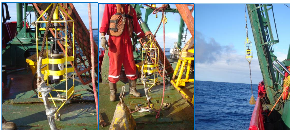
FIGURA 3.3.1-1 Preparação do equipamento e procedimento de lançamento do CTD Sea-Bird SBE19 Seacat Profiler.
