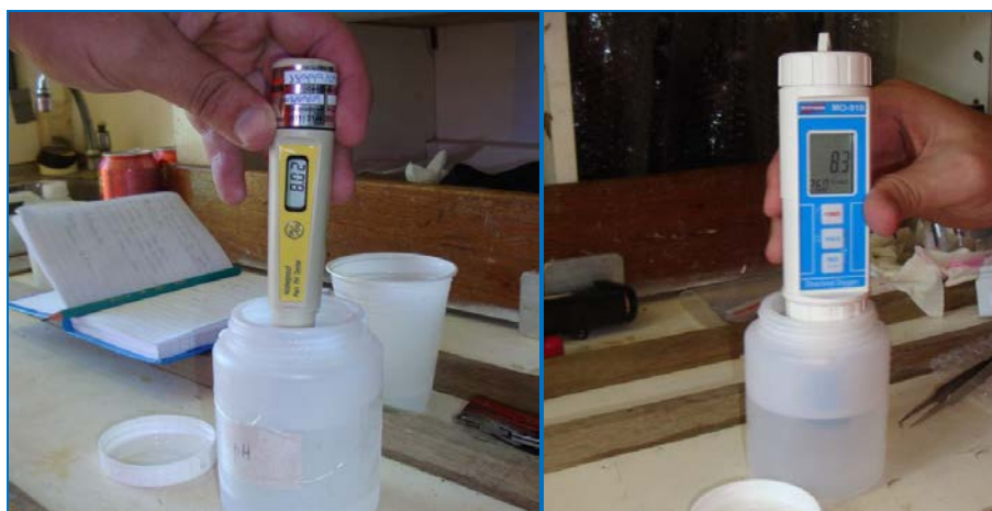
FIGURA 3.3.2-2 Equipamentos utilizados para medição in situ de pH e OD, a partir de alíquotas da amostra de água obtida com a garrafa de Niskin.
