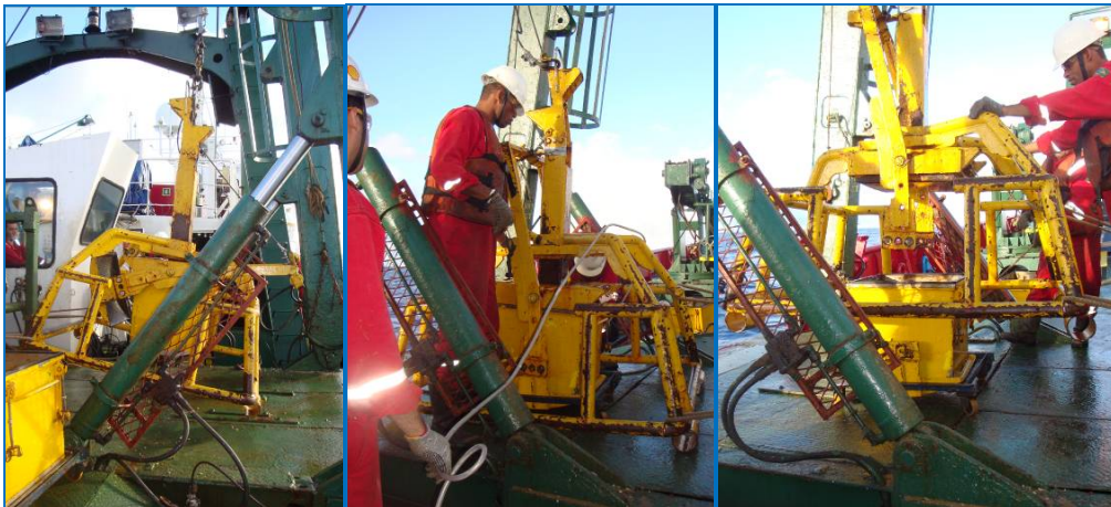
FIGURA 3.3.3-1 Procedimento de lançamento e manuseio do box-corer a bordo do Fugro Odyssey, durante a campanha de monitoramento ambiental realizada na Bacia de Campos.
