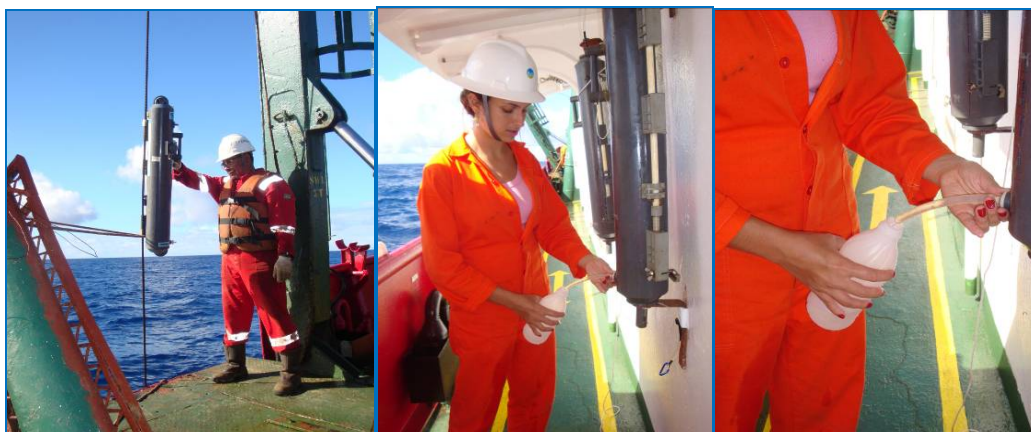
FIGURA 3.3.2-1 Procedimento de coleta das alíquotas de água das garrafas Niskin durante a campanha de monitoramento ambiental regional realizada na Bacia de Campos.
