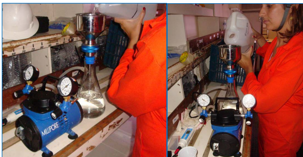
FIGURA 3.3.4-1 Procedimento de filtração de alíquota de água para amostragem de pigmentos clorofilianos, na campanha de monitoramento realizada na Bacia de Campos.
