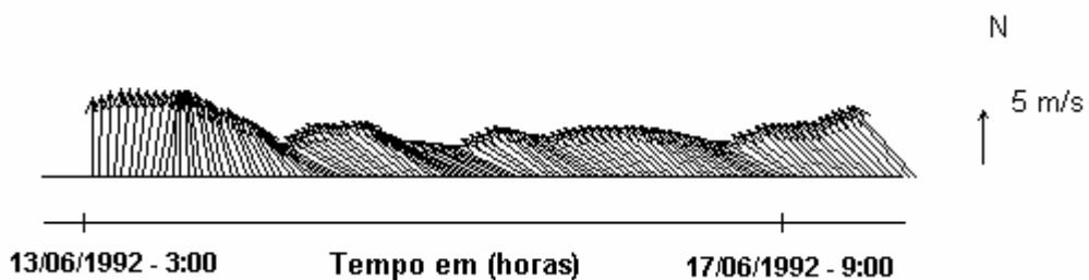
Figura 44 - Diagrama stick plot dos vetores de vento para o cenário determinístico crítico de inverno, a partir do início da simulação até o primeiro toque na costa.
