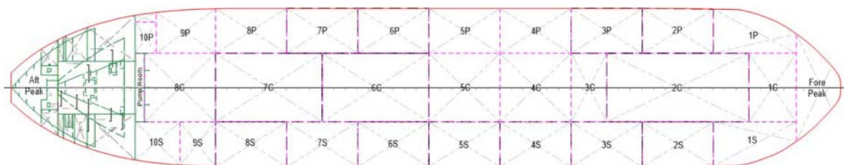
Figura 3.2.2.1 – FPSO Fluminense - Layout dos Tanques
