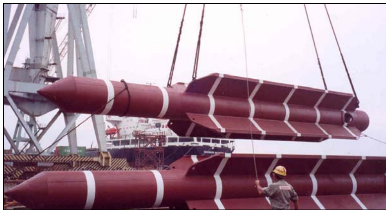
Figura 9. Âncora a ser utilizada para amarração do FPSO P-50.
