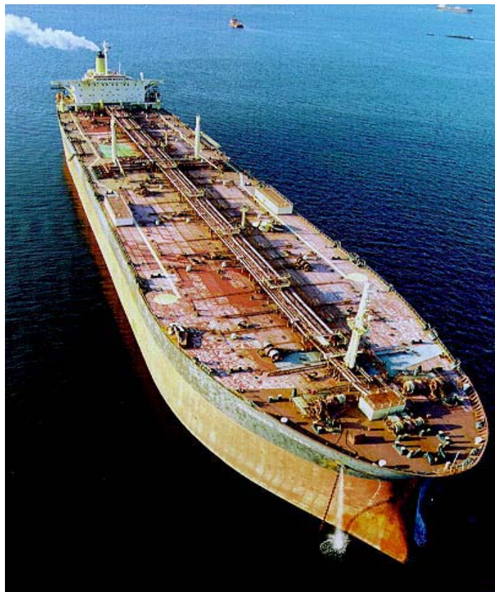
Figura 7. Foto do petroleiro Felipe Camarão a ser convertido ao FPSO P-50.
