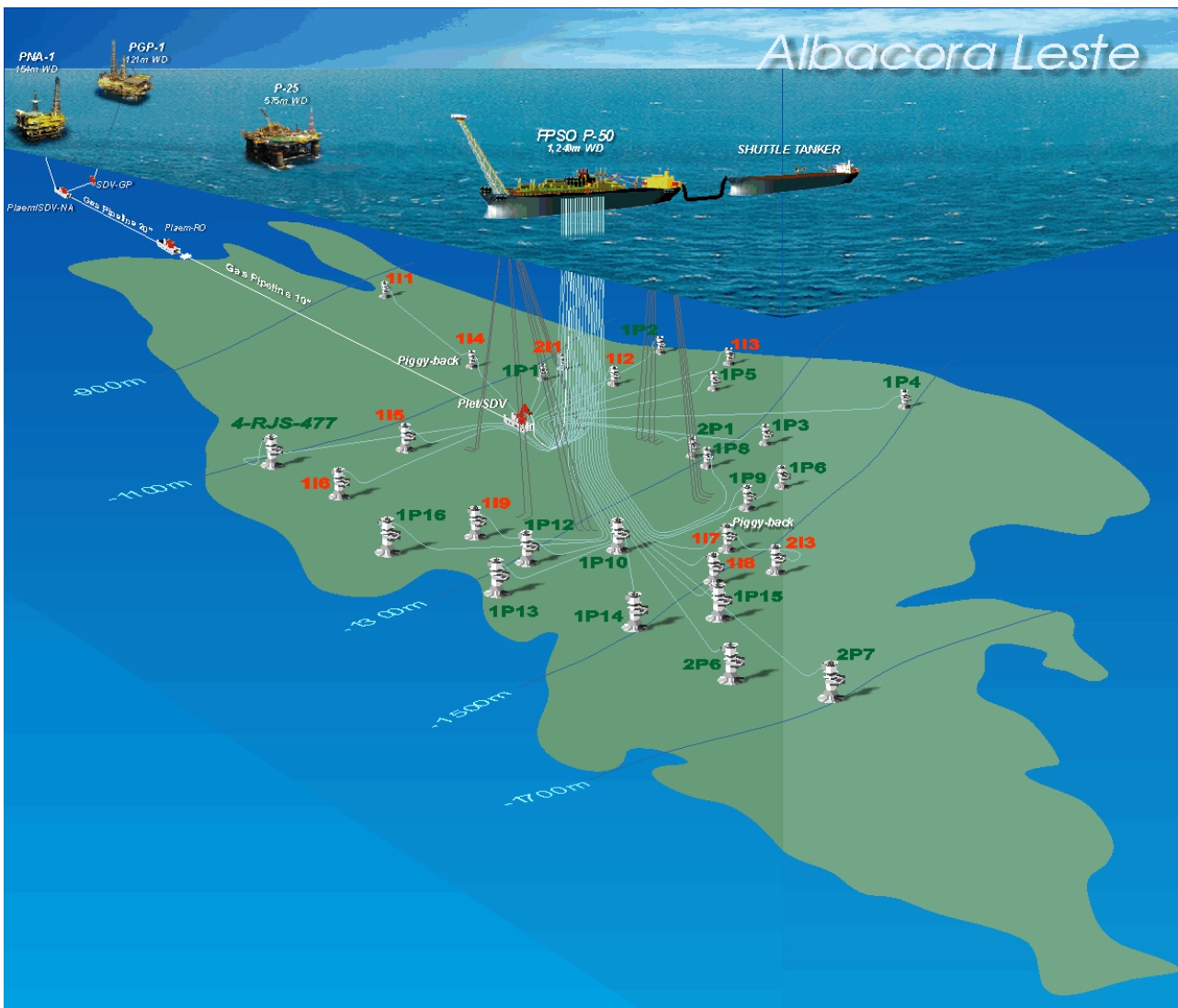
Figura 3. Ilustração do sistema de produção do FPSO P-50 no campo de Albacora Leste Fonte: Petrobrás
