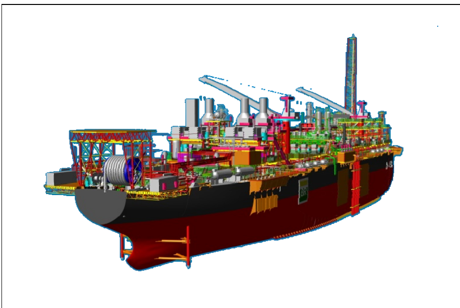
Figura 1: Unidade Estacionaria de Produção (UEP) tipo FPSO
