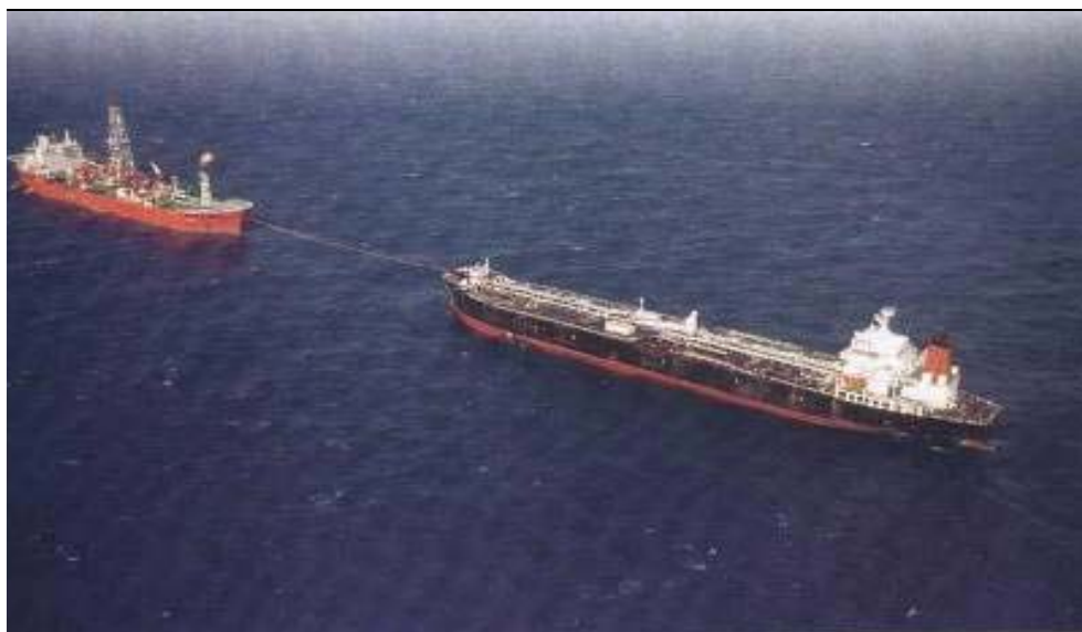
Figura 4: Navio aliviador em operação
