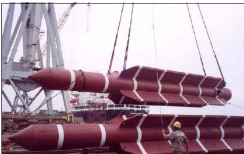
Figura 9: Torpedo de Ancoragem do FPSO
