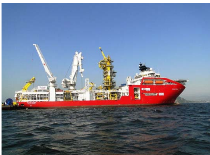
Figura 11 - Barco de lançamento de dutos de coleta – PLSV
