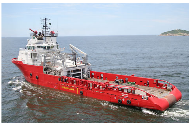
Figura 12- Barco de ancoragem de UEP – AHTS
