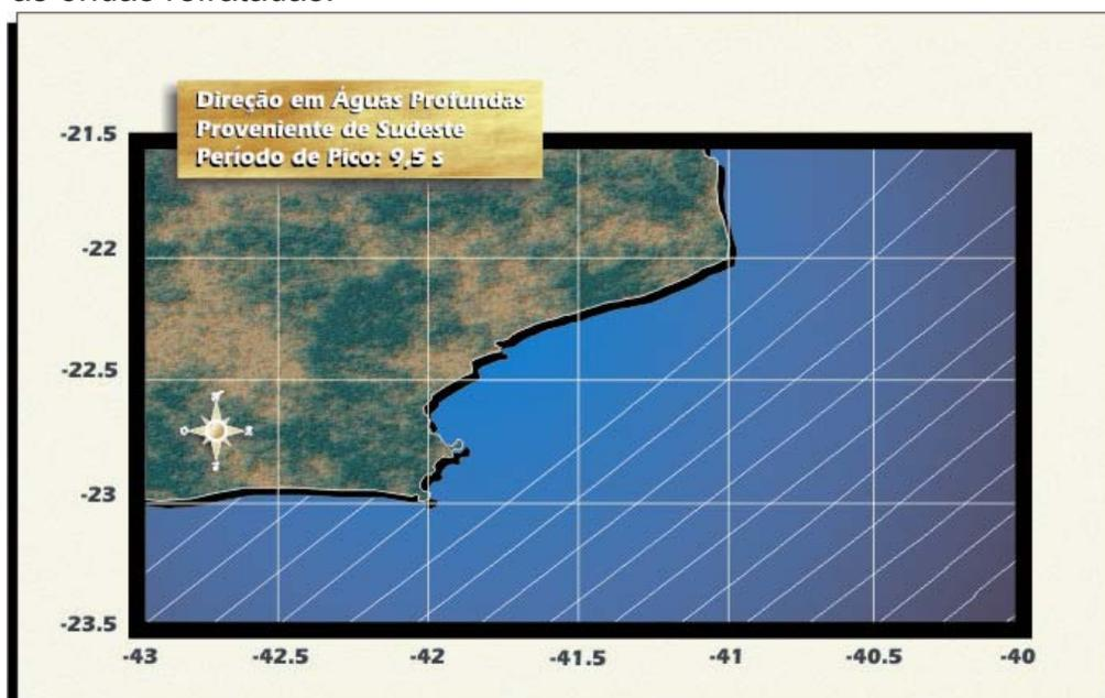
**Figura II.5.1.2-31:** Refração a Leste do Rio de Janeiro de ondas provenientes de Sudoeste com período de 9,5 segundos. . (adaptado de GUERRA, 1994).
