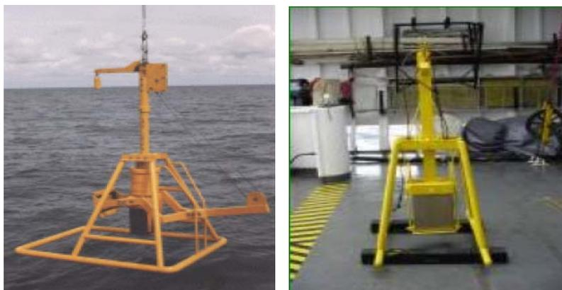
**Figura II.5.1.3–4** - Caixa de Coleta de Sedimentos “Box corer” para aquisição de amostras de sedimento em ambiente marinho (Foto: Internet, 2006).
