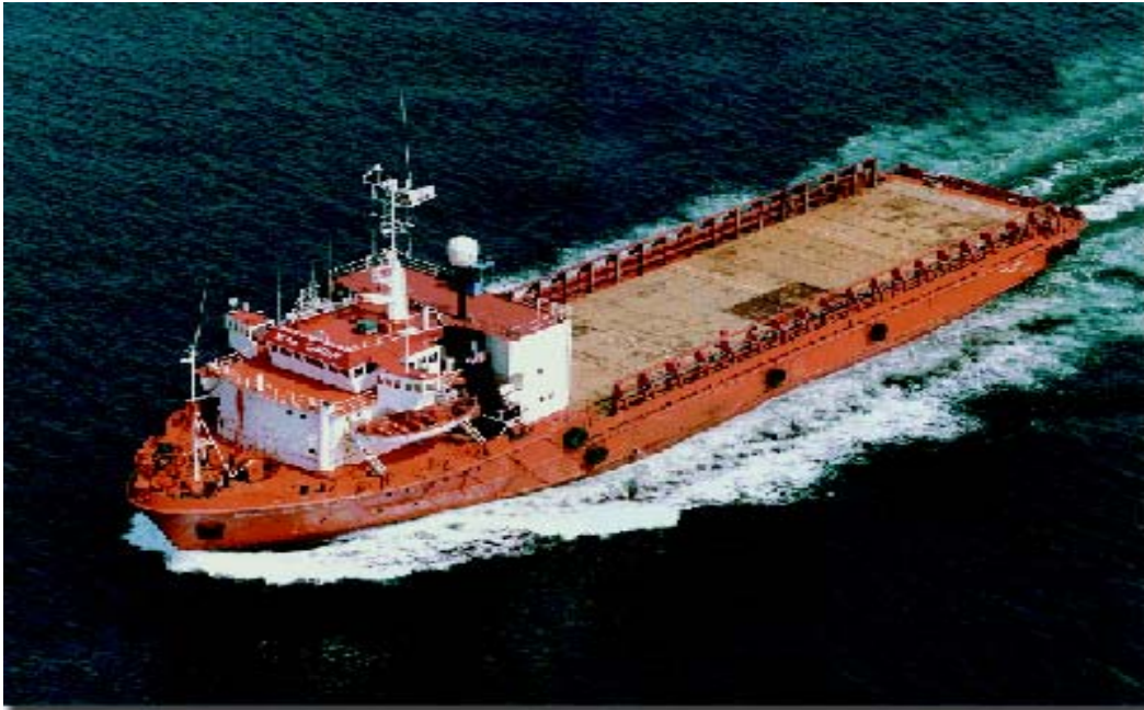
Figura II.2.4-15 - Embarcação Pipe Carrier que transporta dutos para a BGL-1.
