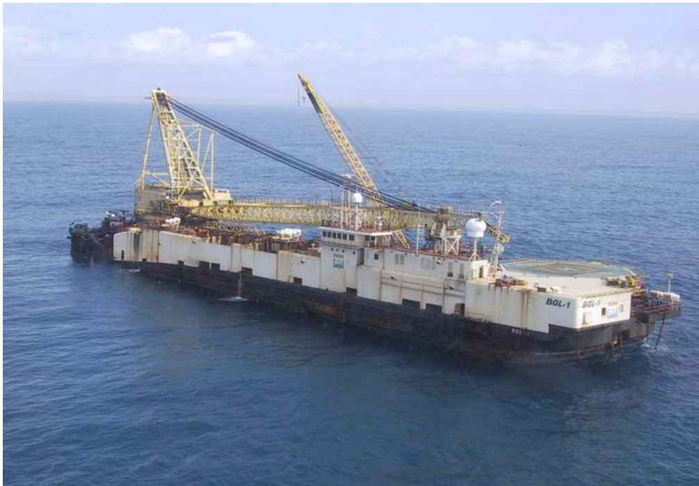
Figura II.2.4-13 - Balsa Guindaste para lançamento do gasoduto em águas rasas.
