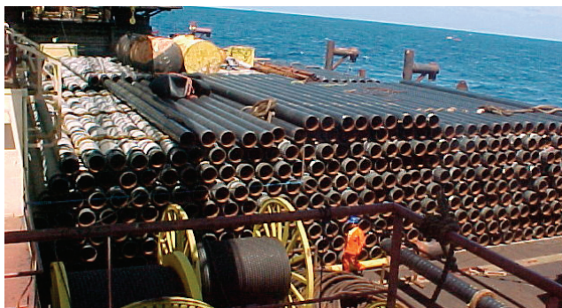
Estaleiros de dutos no interior da BGL-1.
