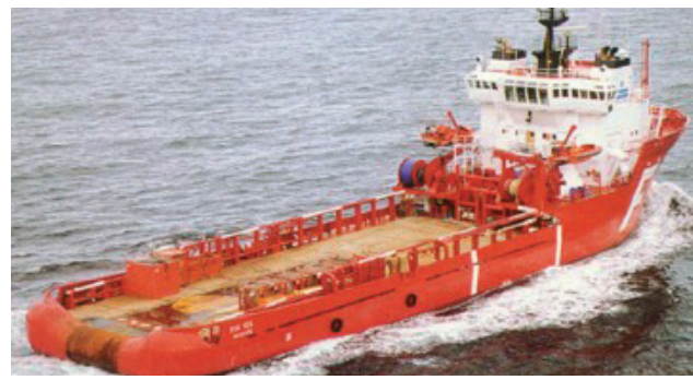
Embarcação tipo AHTS para movimentação das âncoras da BGL-1.
