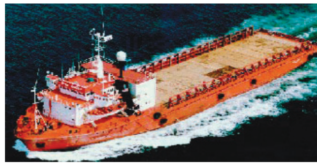
Embarcação Pipe Carrier que transporta dutos para a BGL-1.
