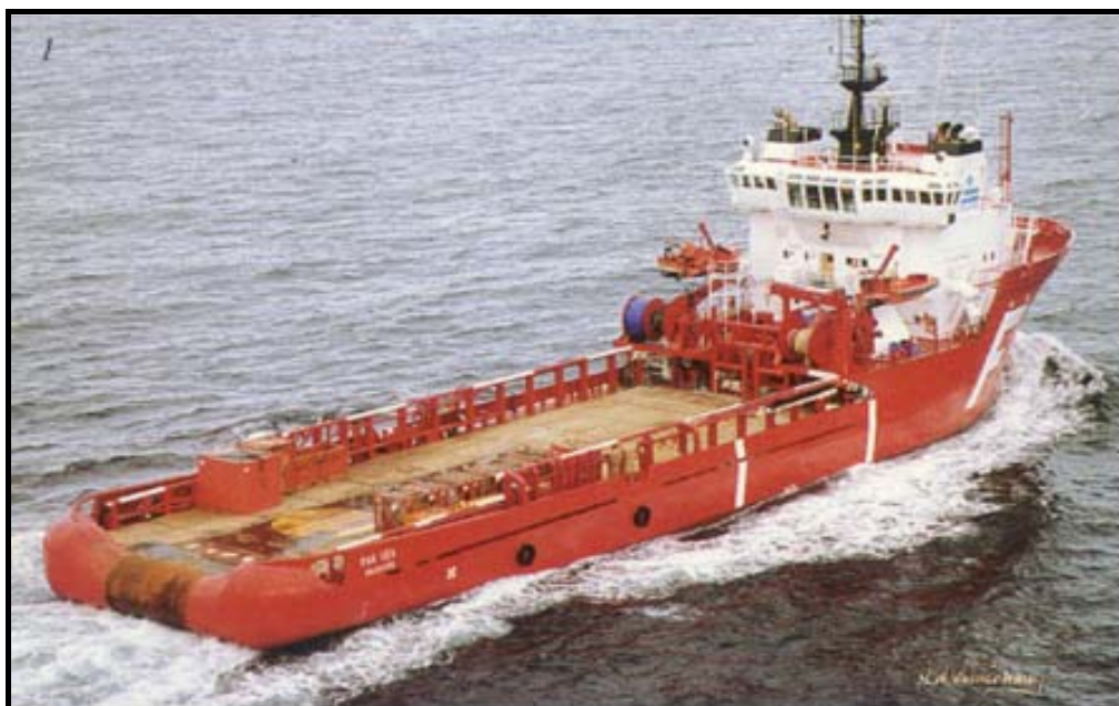
Figura V.2.1-4 - Embarcação tipo AHTS para movimentação das âncoras da BGL-1
