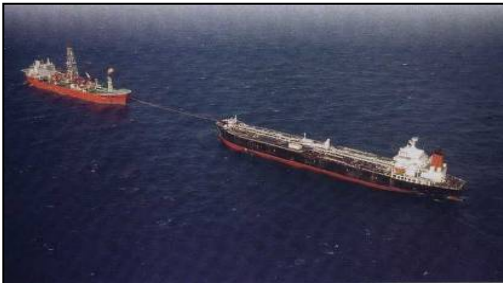
Figura III.3-8 - Vista aérea da operação de offloading de um FPSO para um navio aliviador
