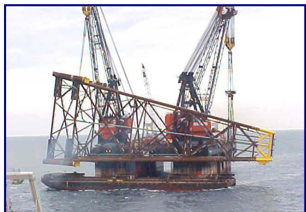
FIGURA II.15-7: EXEMPLO DO TRANSPORTE DAS ESTACAS DE FUNDAÇÃO DA PLATAFORMA
