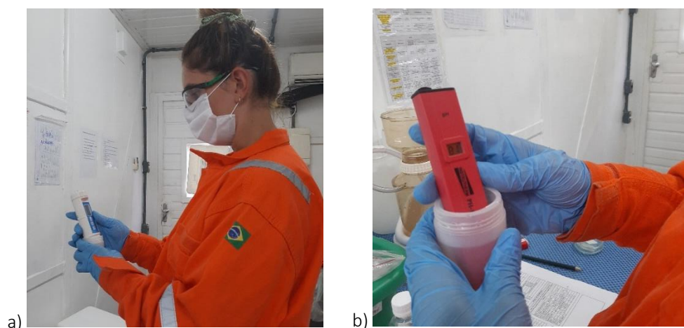
Figura 17: Medição de OD (a) e pH (b) realizadas no campo.
