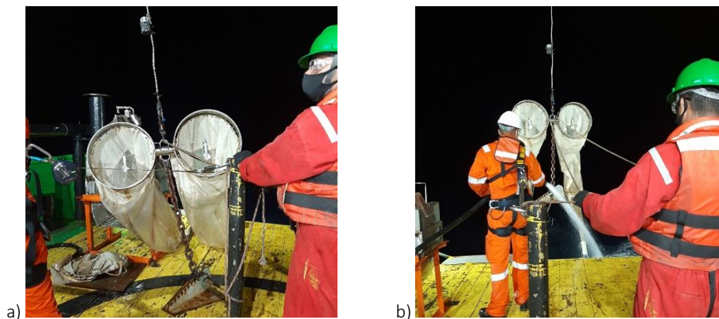
Figura 28: Lançamento (a) e lavagem (b) da rede bongô de 330 µm e 500 µm para arrasto de ictioplâncton.
