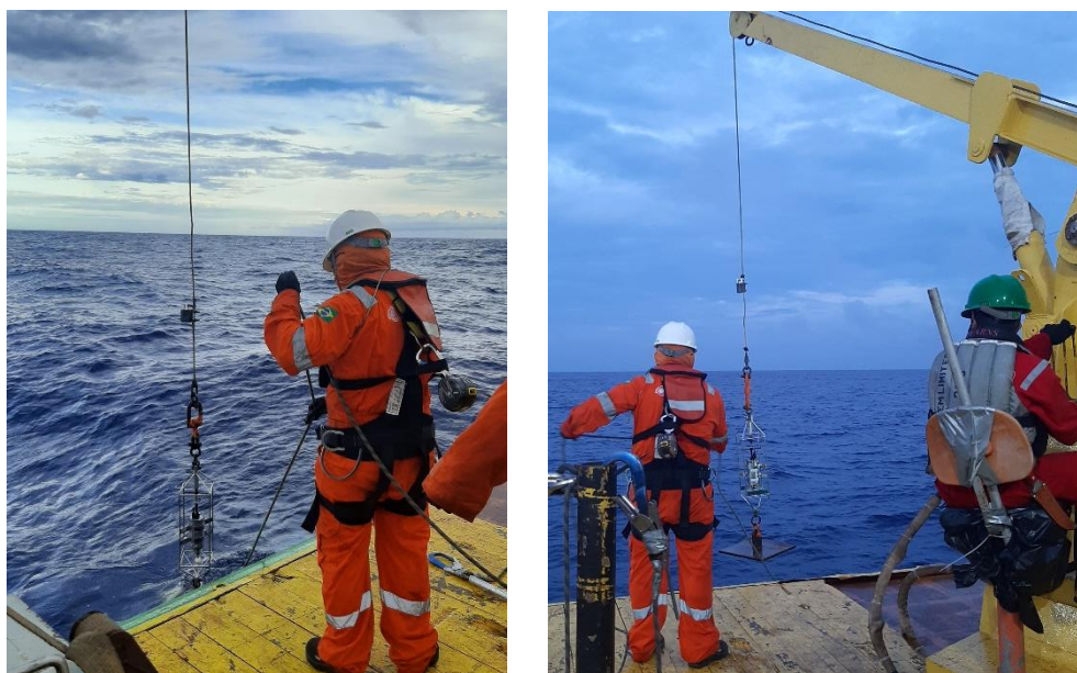
Figura 14: Lançamento do CTD para perfilagens ao longo da coluna d'água.
