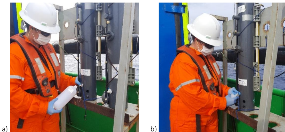
Figura 16: Sangria da garrafa para os diversos parâmetros. a) retirada para fenóis b) amostra para OD e pH.
