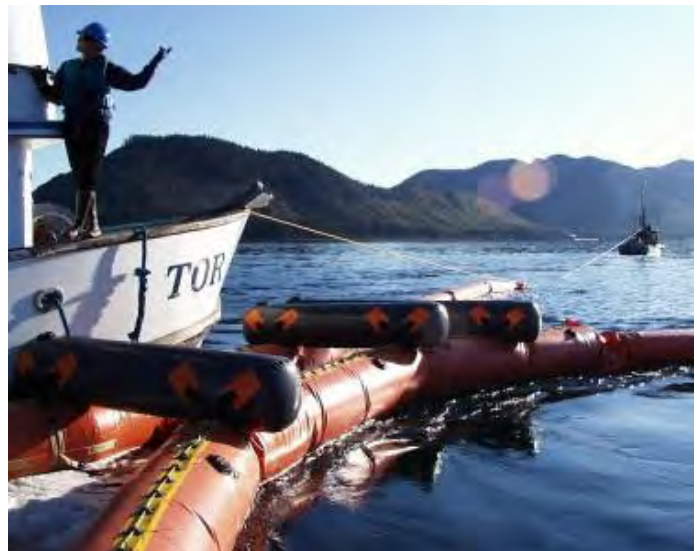
Fig. 36: Cabo de atracação da proa da embarcação de bombeamento até o ponto de conexão entre a varredura e o cabo de reboque. (Imagem do NOFI Current Buster 4)
