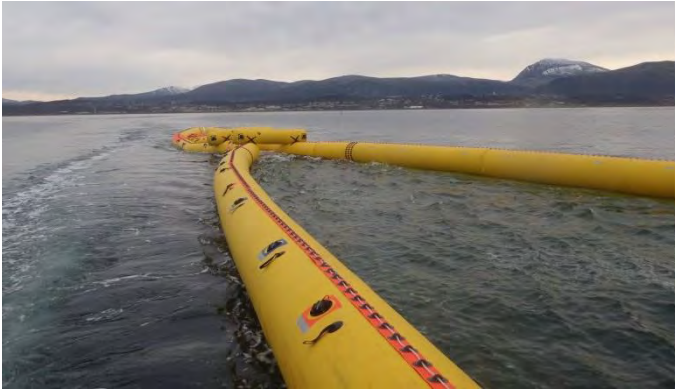
Fig. 2: NOFI Current Buster 6 à velocidade de reboque de 4 nós
