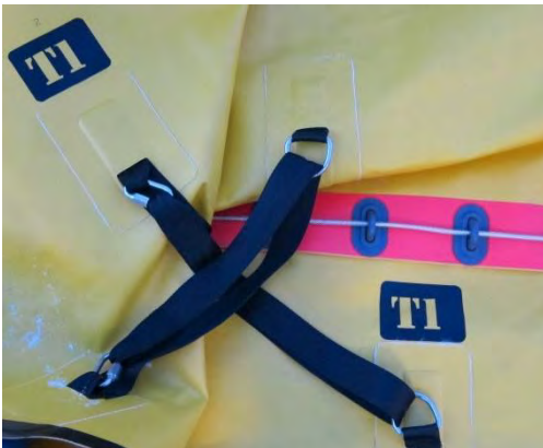
Fig. 15: Câmaras transversais com codificação numérica. As correias de fixação cruzadas aplicam-se apenas às câmaras transversais 1 e 2.
