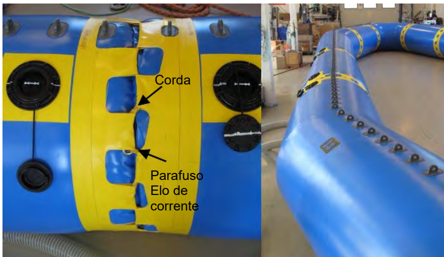
Fig. 13: Conexão da estrutura de flutuação
